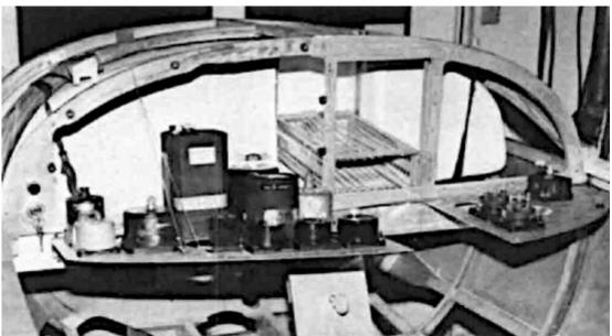
Cette vue montre les deux panneaux ouverts. Le grand à gauche est monté sur amortisseurs sur ses charnières. Le renfoncement du réservoir est très prononcé. Le long du haut du montant du tableau d'instruments se trouvent trois unités d'amortissement montées horizontalement, et trois autres de chaque côté de l'ouverture du panneau.
