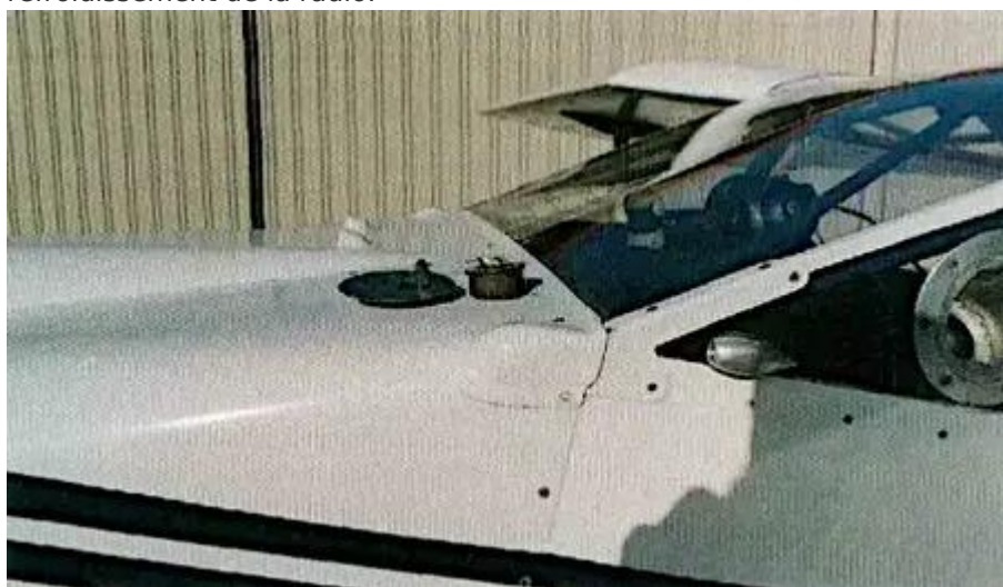
Couvercle affleurant et bouchon de bouteille Thermos.
