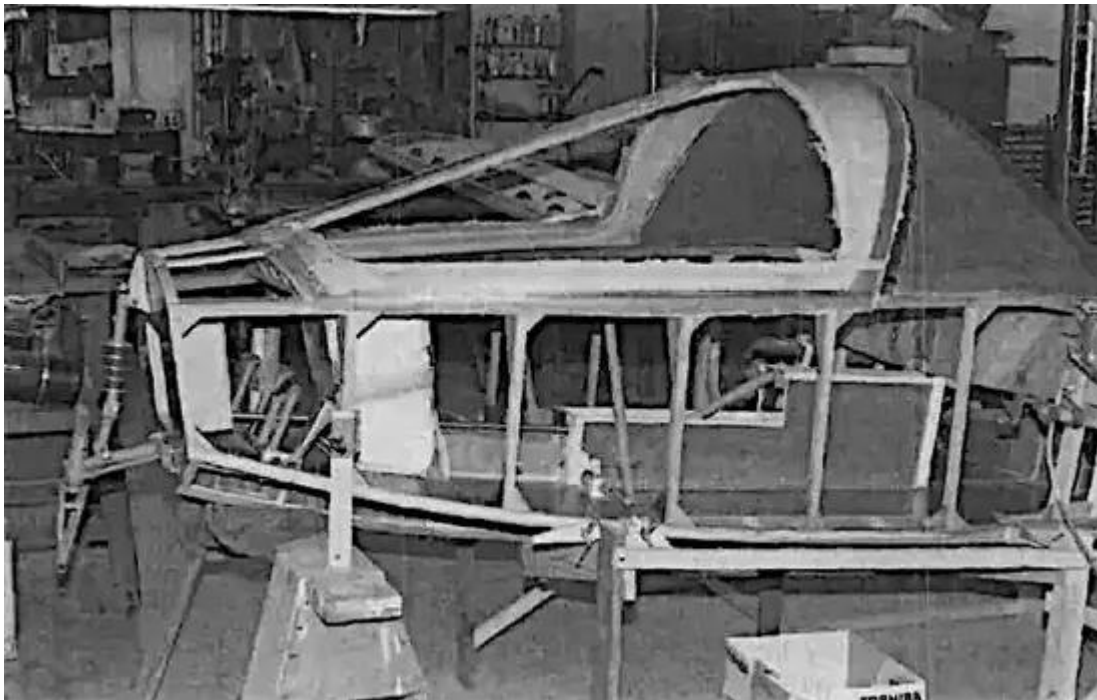
Un fuselage d'Osprey II sans son revêtement en contreplaqué révèle l'absence de renforts diagonaux. Ceux-ci sont souvent inutiles lorsque la structure doit être recouverte de contreplaqué. Notez cependant que chaque assemblage est renforcé par l'installation de blocs d'angle.
