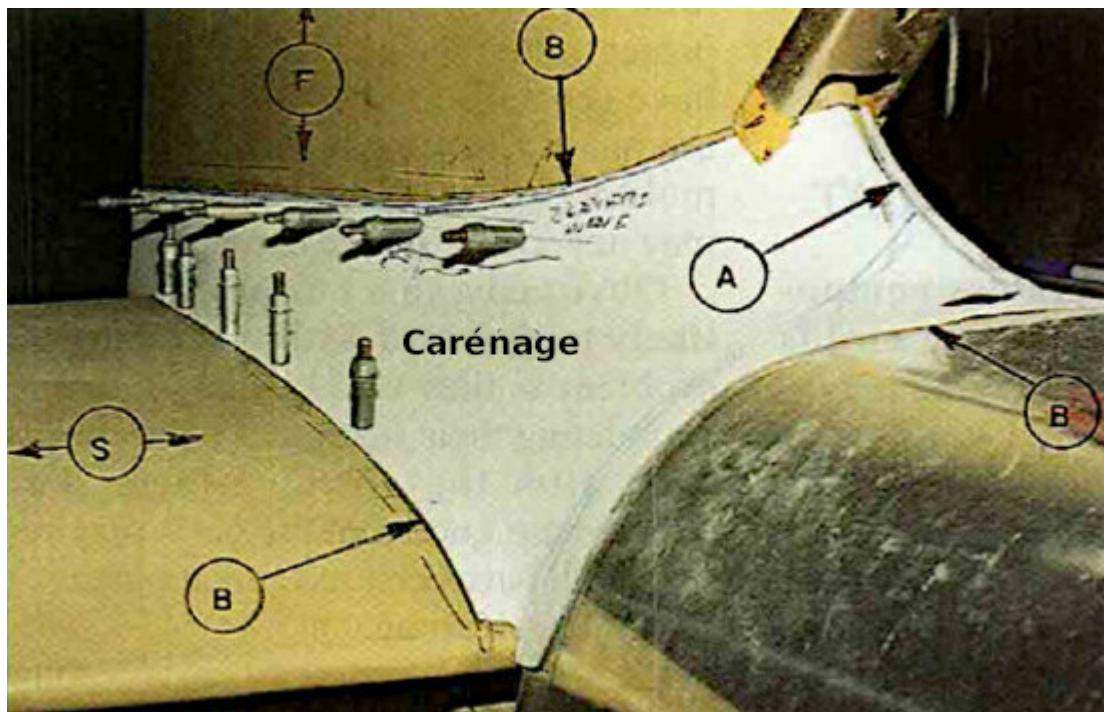
Voici un autre exemple d'un carénage arrière moulé qui ne s'ajustait pas. Le constructeur a dû le découper en (A) et ajouter des couches de fibre de verre sur les zones inférieures marquées (B) afin d'obtenir un ajustement parfait.
