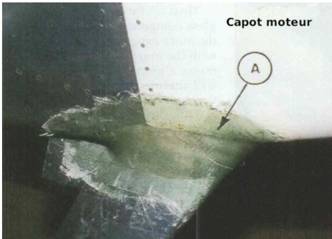
Voici un petit travail typique de fibre de verre : la fabrication d'un carénage de jambe de train vers capot.
