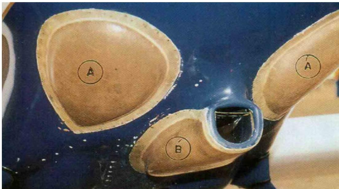
Lorsque ce constructeur a reçu son capot, il a constaté qu'il était fortement déformé et mal ajusté dans les zones marquées (A). Il a appliqué de la chaleur et de la pression, mais n'a pas réussi à le « redresser » complètement. Finalement, il a dû ajouter des couches supplémentaires de fibre de verre, comme indiqué, pour effectuer les corrections nécessaires.
