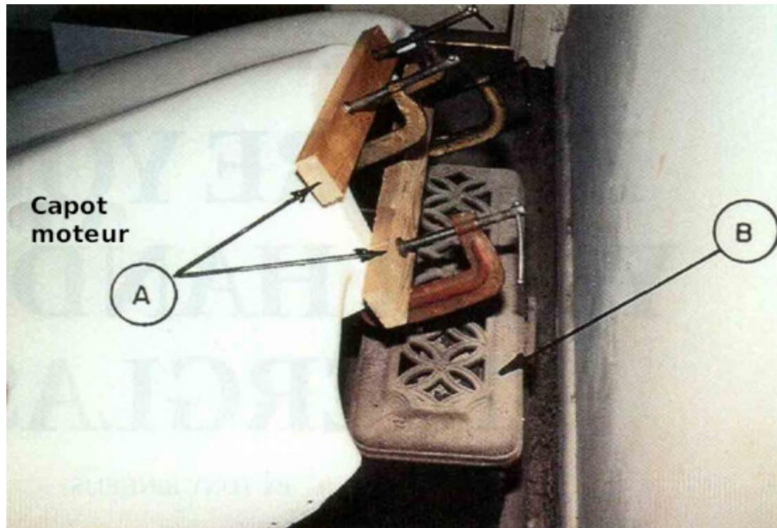
Un chauffage d'appoint (B) est utilisé pour chauffer le capot afin de le rendre malléable. Les cales et les serre-joints sont utilisés pour forcer le capot à s'aligner. Après un certain temps de chauffage, celui-ci a été éteint et le capot a été laissé à refroidir. Après refroidissement, il a conservé le contour corrigé.
