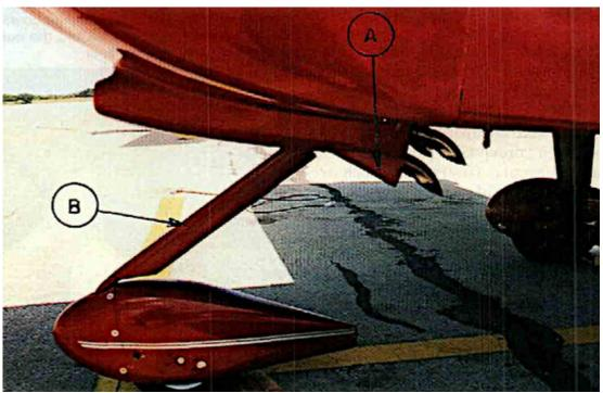
Cette photo identifie quelques endroits où le constructeur doit faire un peu de travail en fibre de verre dans l'intérêt de la réduction de la traînée.
