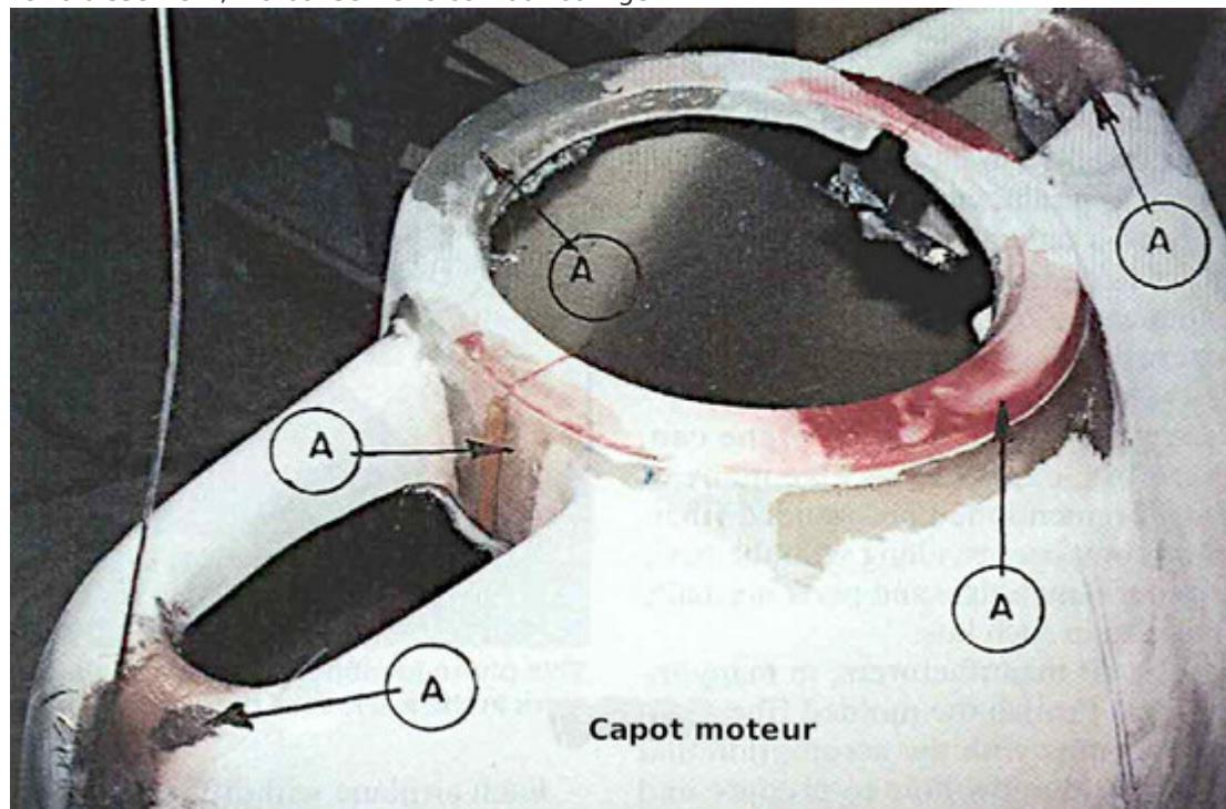
Lorsque ce constructeur a reçu son capot, il a constaté qu'il était fortement déformé et mal ajusté dans les zones marquées (A). Il a appliqué de la chaleur et de la pression, mais n'a pas réussi à le « redresser » complètement. Finalement, il a dû ajouter des couches supplémentaires de fibre de verre, comme indiqué, pour effectuer les corrections nécessaires.
