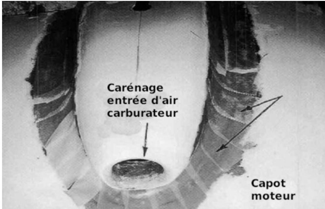
Cette prise d'air de carburateur a dû être remplacée afin de fournir le dégagement nécessaire au niveau de la boîte du filtre à air du carburateur. Du ruban en fibre de verre de 3" (A) a été utilisé pour harmoniser les contours. On peut voir qu'il reste beaucoup de travail de ponçage à effectuer.
