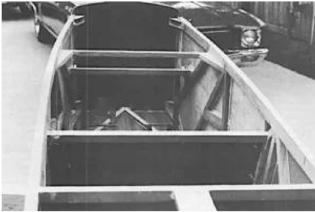
Ce constructeur a utilisé la colle époxy FPL-16A pour l'assemblage de son fuselage. C'est une bonne colle, mais comme il s'agit d'une colle blanche, un inspecteur pourrait la confondre avec une colle blanche de menuisier non acceptable... soyez prêt à prouver que ce n'en est pas une.
