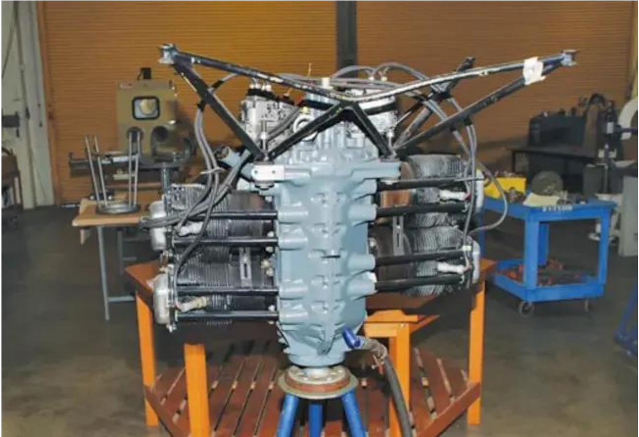
Un moteur O-290 avec supports coniques est montré sur un bâti moteur.
