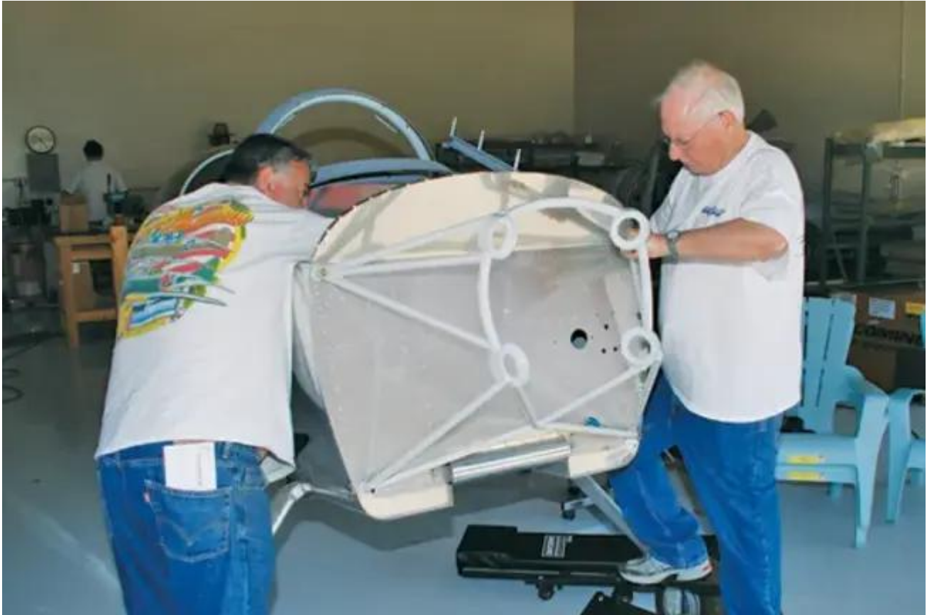
Installation d'un bâti moteur Dynafocal sur le Van's RV-8 de Rohwedder. Ce bâti supportera bientôt un moteur IO-360.
