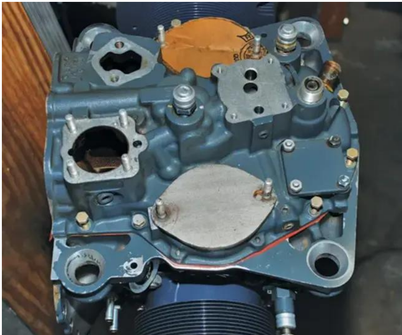
Ce carter moteur O-360 plus ancien a des trous de bâti moteur qui sont coniques. Il nécessitera un bâti conique pour le fixer à un avion.
