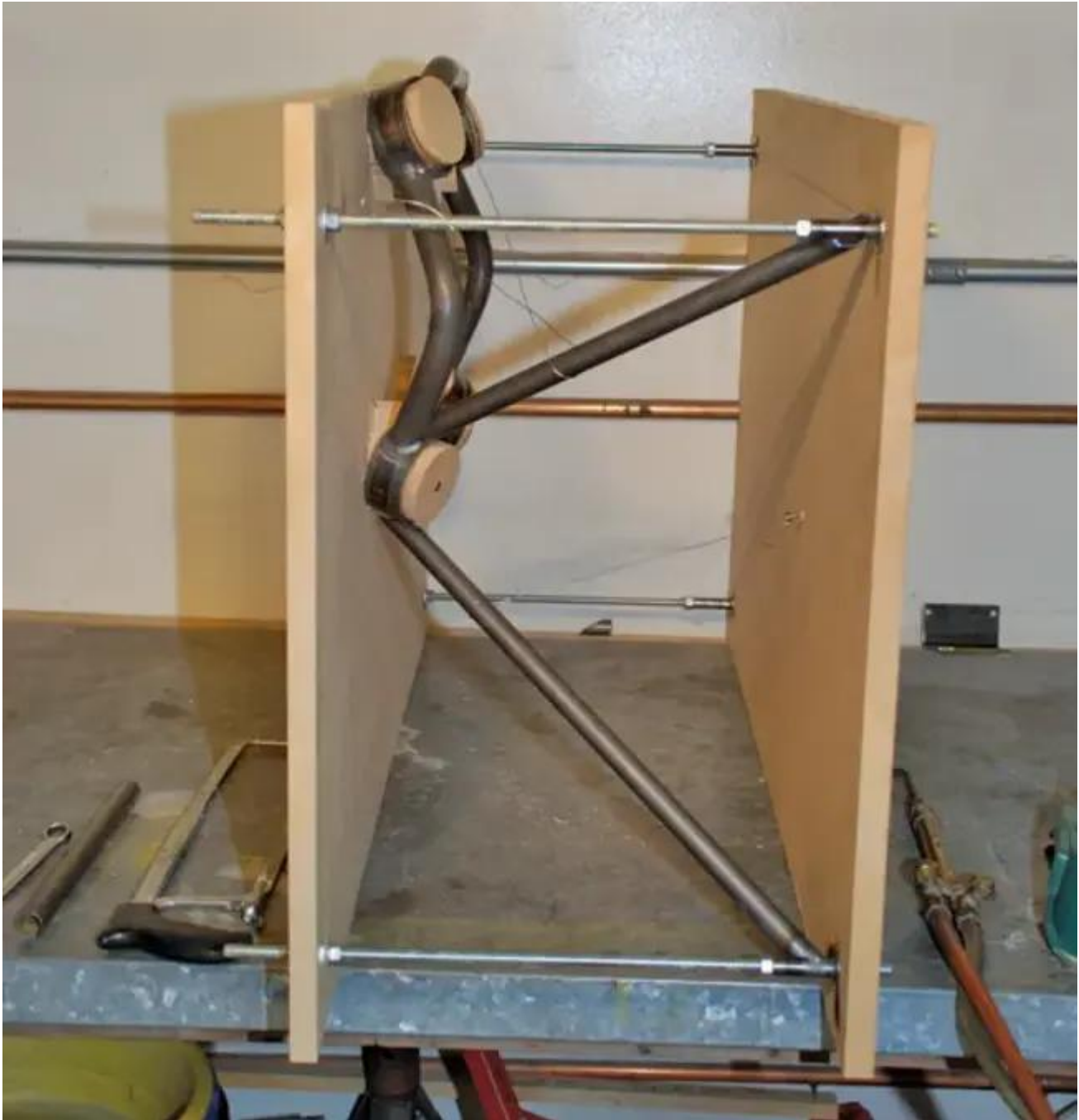
Un gabarit de bâti moteur à usage unique peut facilement être fabriqué à partir de panneau de particules et de tiges entièrement filetées. Ce gabarit est configuré pour fabriquer un bâti Dynafocal pour un RV-8.
