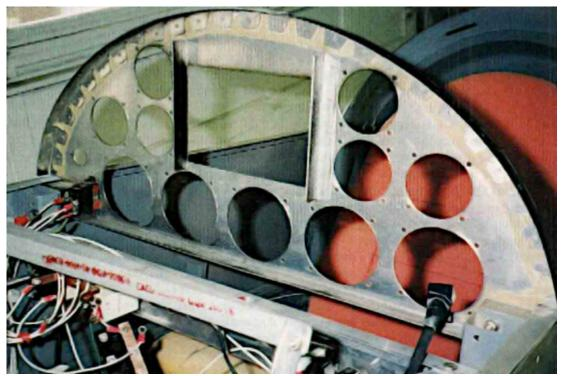
Pour simplifier l'installation de votre tableau de bord et pour assurer un accès facile lors de futurs besoins de maintenance, essayez de regrouper vos unités et connexions électriques dans un souspanneau facilement amovible, monté sous le panneau principal d'instruments.
