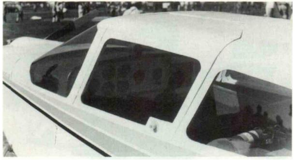
Une verrière de type porte est le choix préféré des constructeurs d'avions. Toutefois, un constructeur amateur doit comprendre qu'une large découpe dans le toit est nécessaire pour faciliter l'accès... la plupart des constructeurs amateurs doivent se contenter d'une ouverture de porte plus petite, car découper un longeron est risqué à moins que cela ne soit soigneusement conçu.
