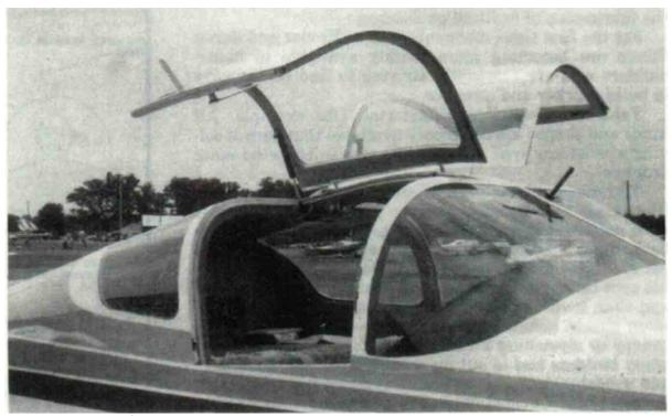
Au lieu d'une verrière, pourquoi ne pas installer des portes en « ailes de mouette » ? Un pare-brise plat incurvé et des vitres arrière peuvent être utilisés, bien qu'un moulage à chaud des vitres sur un moule spécial soit nécessaire. Ce type d'installation est facile à rendre étanche au bruit du vent... et offre une excellente hauteur sous plafond.
