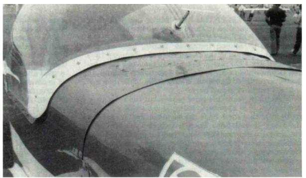
Une verrière coulissante vers l'avant est la plus difficile à ajuster précisément et à rendre étanche au bruit du vent. Un avantage toutefois : un pare-brise et un cadre séparés ne sont pas nécessaires.
