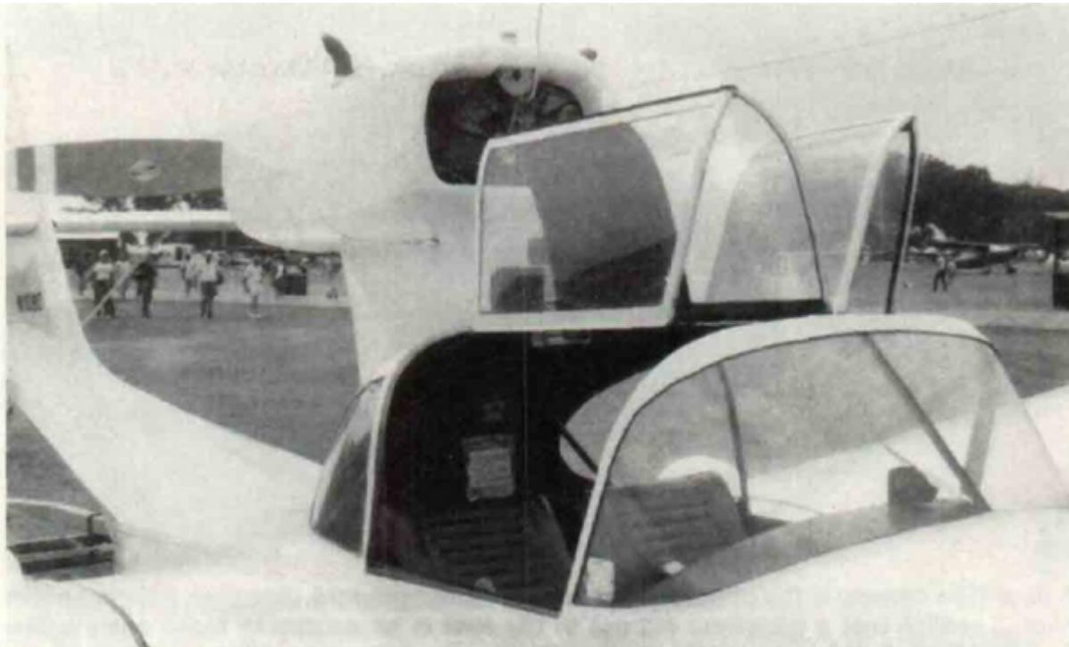
**Une verrière à charnières latérales pourrait être peu pratique sur un amphibie. Ces trappes à double charnière permettent aux occupants d'accoster facilement ou de pagayer sérieusement. Dans ce type d'installation, le cadre du pare-brise et le cadre arrière sont généralement rainurés, et des guides situés à la base des trappes coulissent dans ces rainures.**
