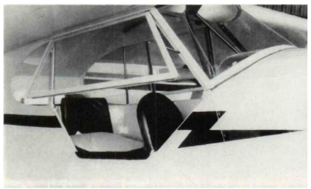
Pour le pilote de loisir amateur de vues panoramiques, ce type de porte est difficilement améliorable. Bien que l'entrée et la sortie soient peu pratiques sur le J-3 Cub, on peut le piloter avec l'une ou l'autre des portes — ou les deux — ouvertes ou fermées.
