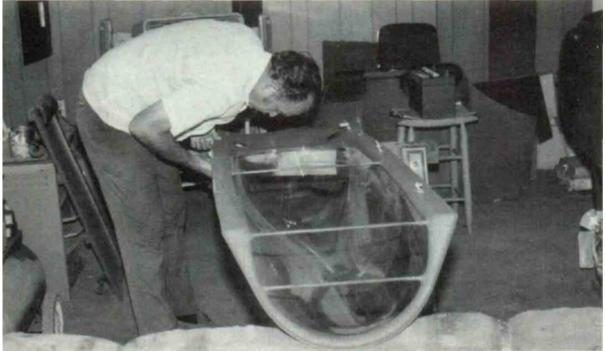
L'installation d'une verrière sur un avion demande une planification, des ajustements et des essais considérables. Même après la fabrication du cadre et le collage de la « vitre » à l'époxy, la mise en place et l'alignement de toutes les charnières et de la quincaillerie peuvent prendre bien plus de temps que ce que la plupart des constructeurs imaginent.
