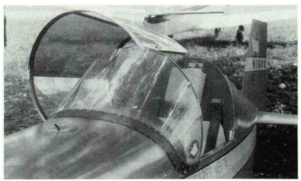
La verrière basculante à charnières latérales est la plus populaire de toutes. Elle est particulièrement appréciée des constructeurs de monoplaces, car elle est également la plus simple à installer et à sécuriser. Le pare-brise peut être séparé ou intégré à la verrière.
