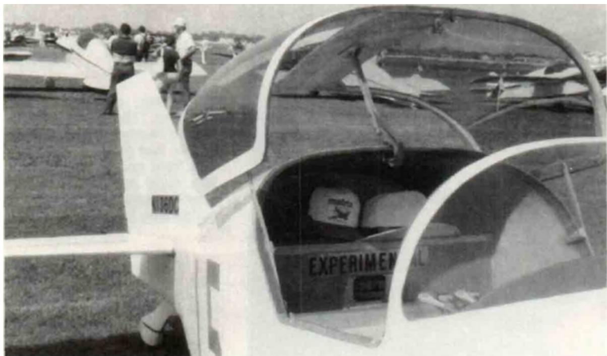
**Une verrière basculante vers le haut est, au mieux, un modèle qui nécessite une attention particulière à la géométrie du mécanisme de charnière. Sur un biplace, la verrière, assez lourde, est difficile à stabiliser face aux rafales latérales (rafales latérales ?).**
