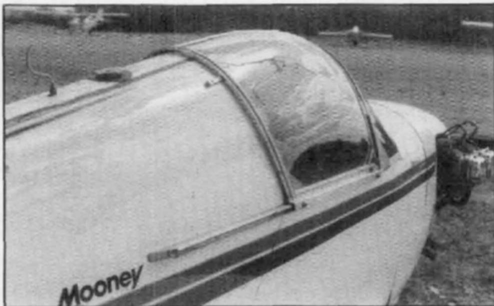
Les extrémités arrière des rails de verrière montés à l'extérieur sont généralement calées pour les écarter du fuselage afin de les rendre parallèles, comme illustré ici sur une installation de Mooney Mite. L'arrêt brusque et non profilé de l'extrémité arrière serait inacceptable pour la plupart des constructeurs.
