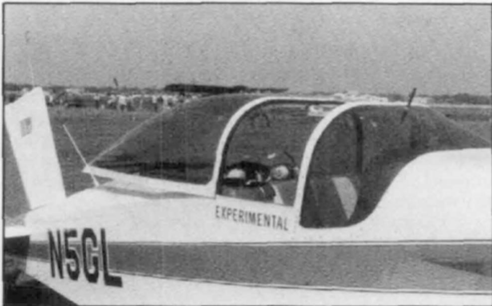
Le dessus aplati est typique de la verrière thermoformée du T-18. Il offre un maximum d'espace pour la tête dans les installations biplace côté à côté. Seul un minimum de garniture métallique a été nécessaire pour cette installation.
