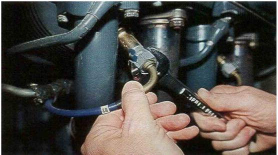
Vissez l'écrou du connecteur de la bougie à la main tout en maintenant le coudé du câble d'allumage pour éviter qu'il ne tourne. Serrez légèrement l'écrou à l'aide d'une clé plate de 3/4".
