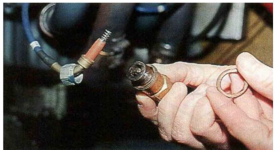
Lors de la réinstallation, remplacez toujours l'ancienne rondelle en cuivre de 18 mm. N'installez pas la rondelle en cuivre standard sur le cylindre qui sera équipé d'une rondelle thermocouple pour le manomètre de température de culasse.
