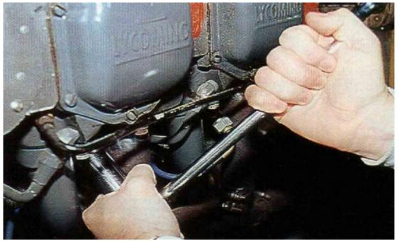
Assurez-vous d'emboîter solidement la clé à bougie sur l'hexagone de la bougie. Utilisez les deux mains pour desserrer la bougie. Prenez garde à ne pas fausser l'alignement de la clé afin de ne pas endommager la bougie.
