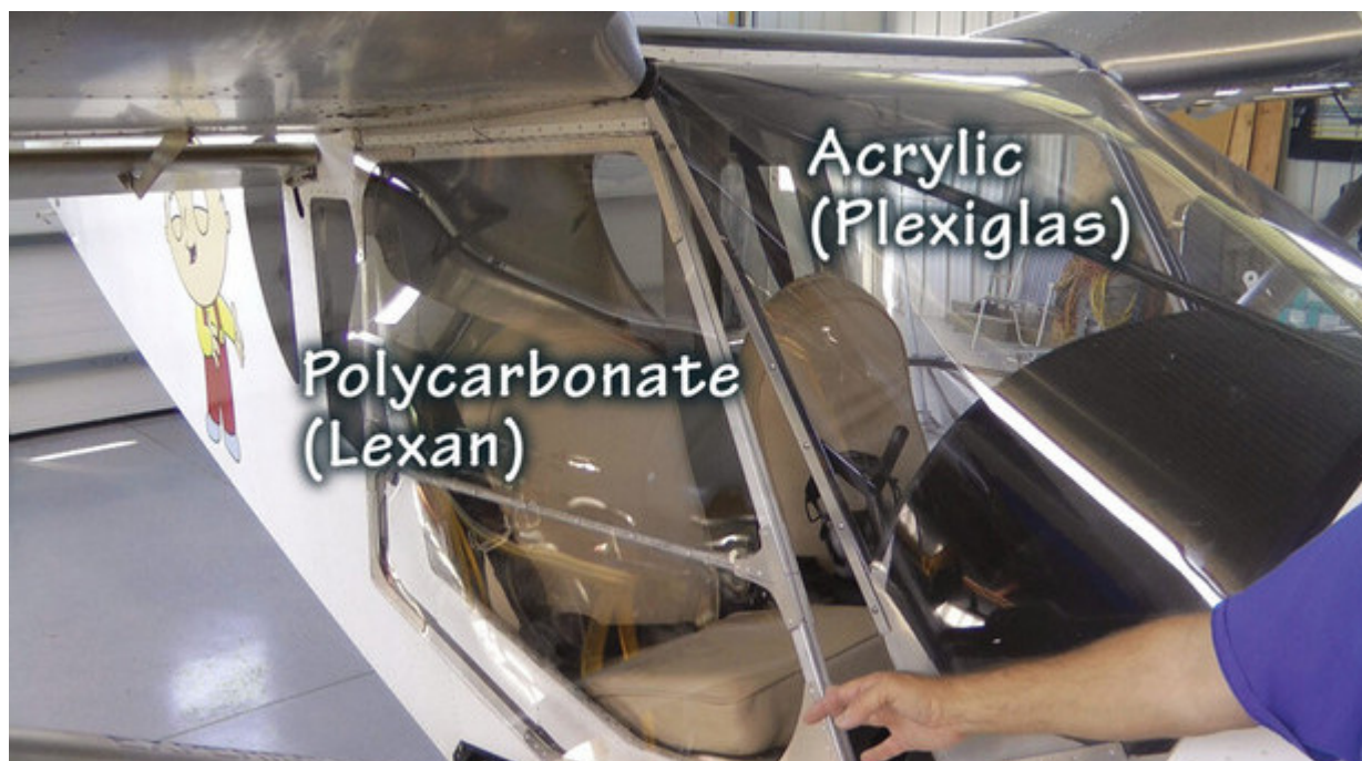
Sur ce Zenith CH 750 Cruiser, le pare-brise est fait d'acrylique (Plexiglas) et les panneaux de porte sont faits de polycarbonate (Lexan).
