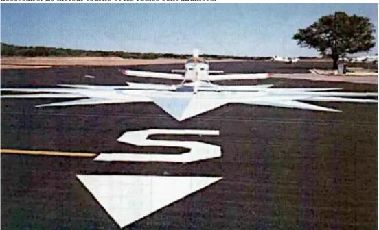
Étape 2 — L'avion est déplacé de façon à s'aligner sur le cap magnétique sud. Déterminez de combien de degrés le compas est erroné sur ce cap, puis corrigez la moitié de cette erreur en réajustant la vis N-S.
