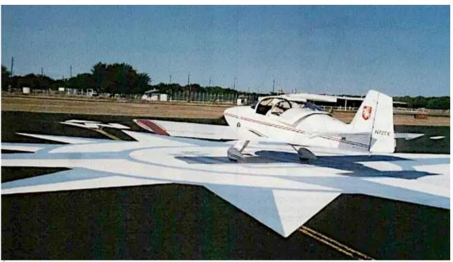
Étape 4 — Alignez l'avion de façon que le nez pointe vers l'ouest. Réajustez la vis E-W afin de corriger la moitié de l'erreur, s'il en existe une.
