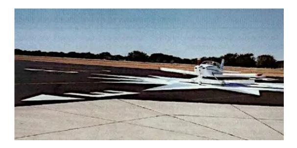
Étape 3 — Alignez l'avion de façon que le nez pointe vers l'est. Ajustez le compas pour qu'il indique E (Est) exactement, en utilisant la vis E-W, si nécessaire.
