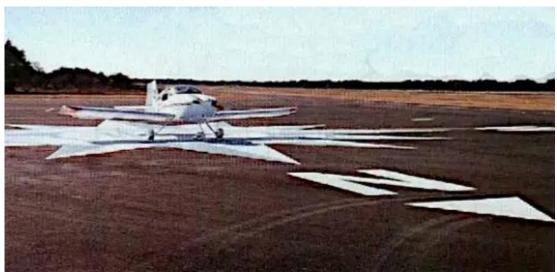
Étape 1 — Le pilote a roulé jusqu'à la rose des vents et aligne le nez de l'avion sur le nord magnétique. Le premier réglage de déviation du compas est effectué en ajustant la vis N-S, si nécessaire. Le moteur tourne et les radios sont allumées.
