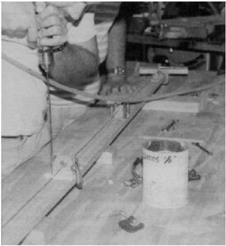
C'est le mauvais endroit pour utiliser un foret long. Ils sont trop flexibles et peuvent déraper et provoquer un agrandissement du trou.
