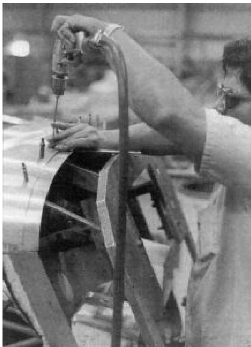
Une perceuse pneumatique est plus rapide et plus légère et
