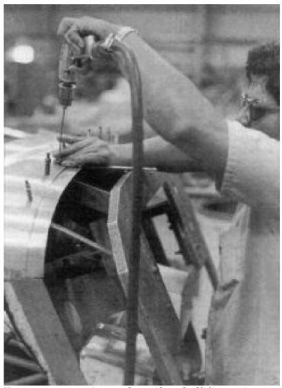
Une perceuse pneumatique est plus rapide et plus légère et moins fatiguante à utiliser dans des positions difficiles qu'une perceuse électrique moyenne.
