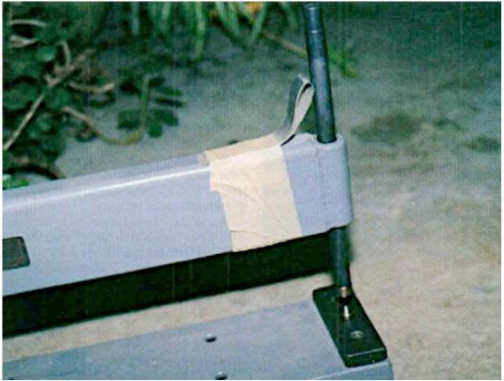
L'outil manuel Avery de rivetage et d'emboutissage à grande profondeur peut être utilisé pour poser les rivets du longeron.
