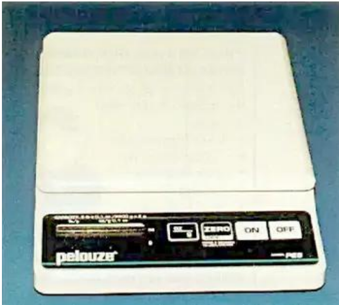
Balance de précision pour la pesée de la résine pour mélange
