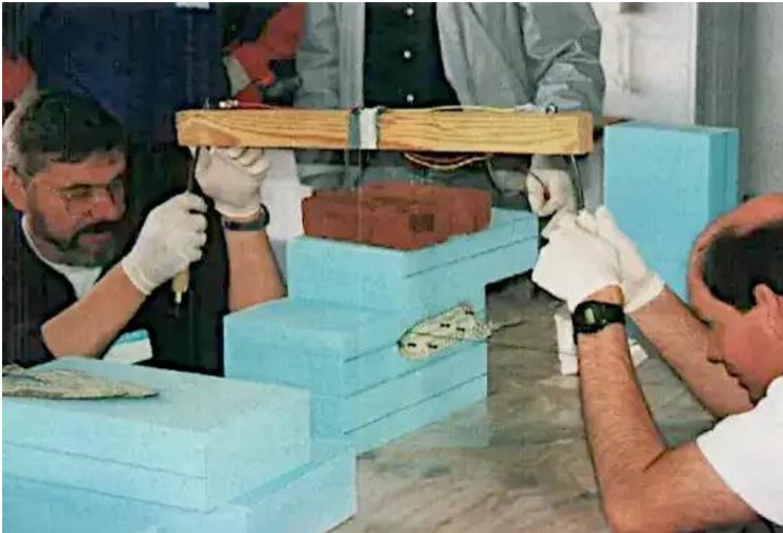
Découpe de la mousse au fil chaud
