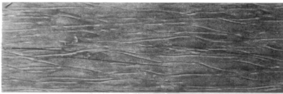
Figure 3 - Cernes en compression tangentielle..
