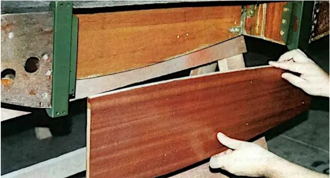
Installation d'une nervure de compression nouvellement construite sur la section centrale de l'aile.
