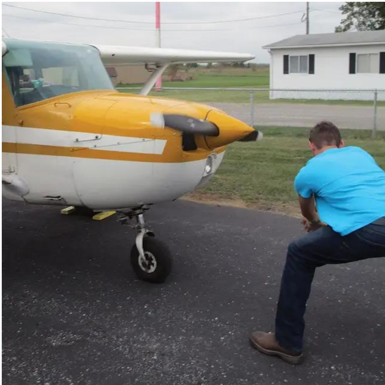
Position dangereuse de mise en route à l'hélice avec un pilote grand, très penché en avant et un Cessna 150.
