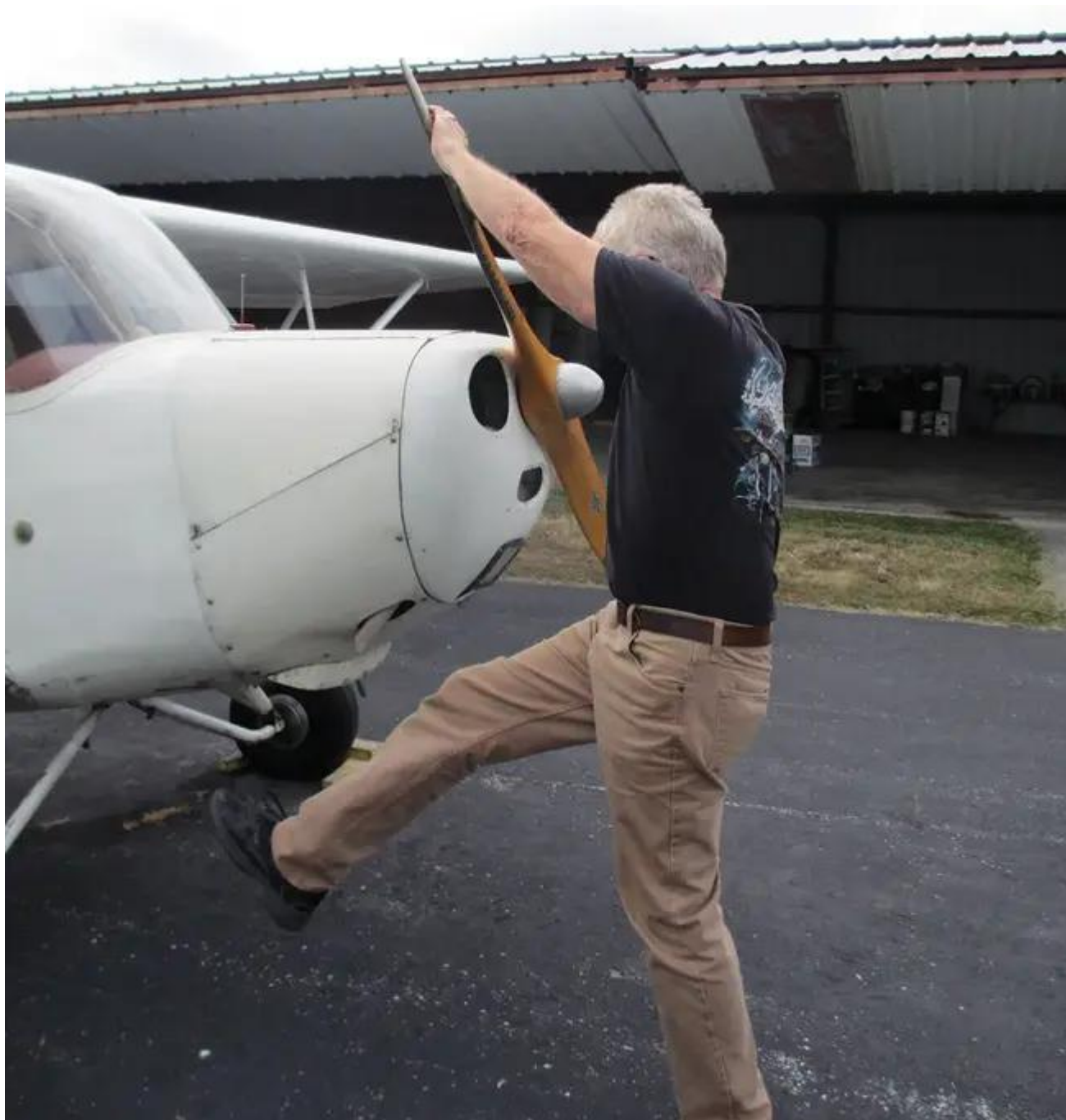
Prendre de l'élan pour le balancement en levant la jambe qui s'écarte ; cela semble dangereux, mais la jambe sera bien à l'écart lorsque l'hélice sera tirée.
