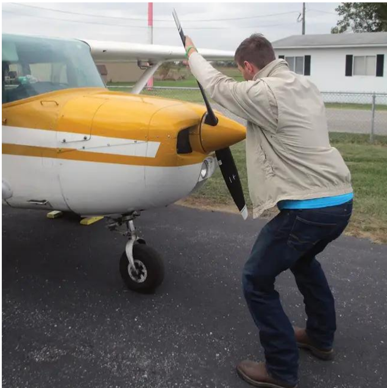
Veste ample pouvant s'accrocher à la pale de l'hélice et gêner le mouvement de traction.
