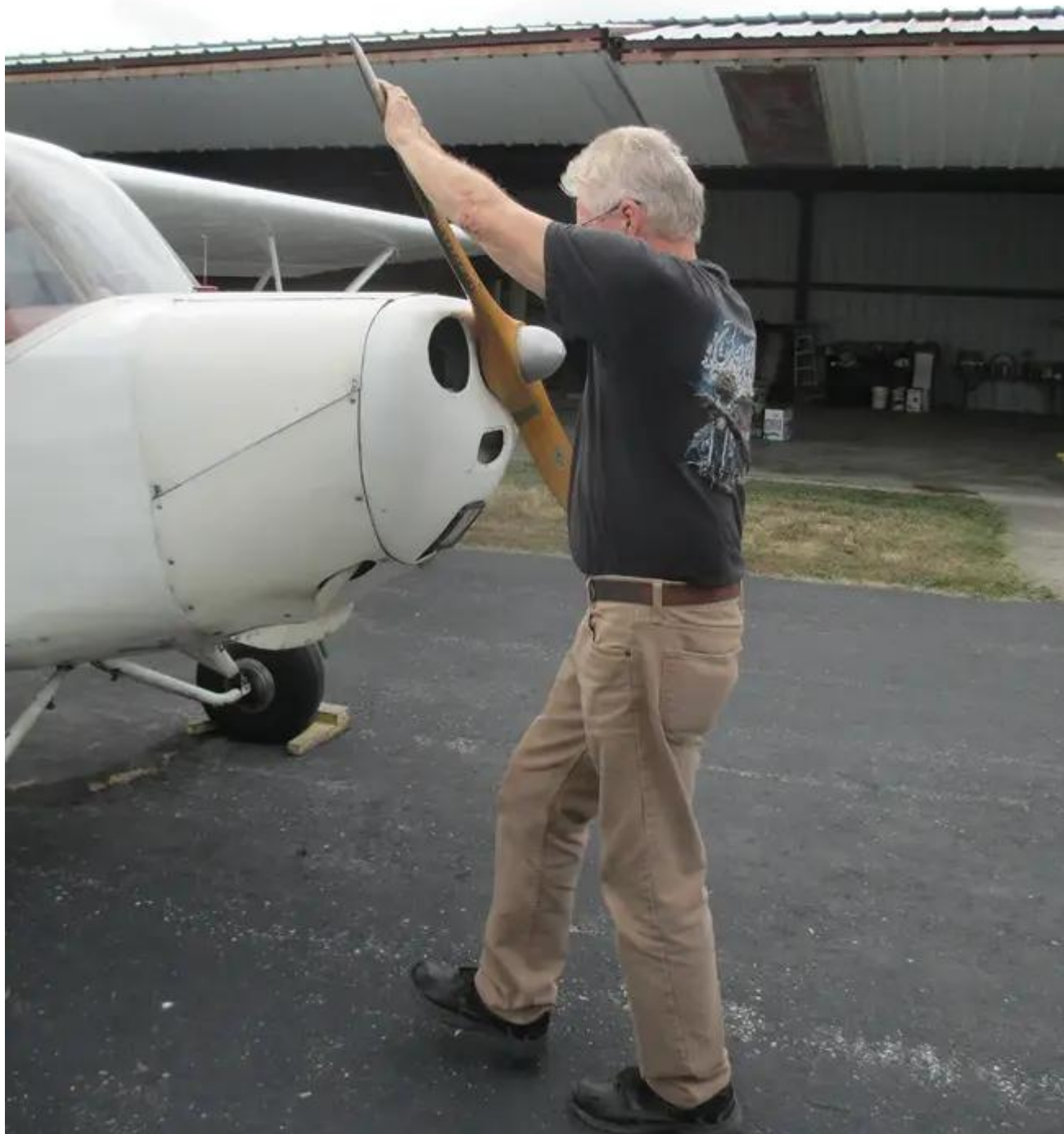
Bonne posture, proche de l'hélice, le moyeu de l'hélice à hauteur de la tête.
