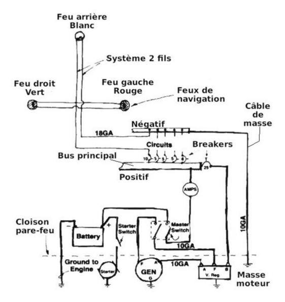
FIGURE 3 Schéma électrique pour avion en bois (les solénoïdes de sont pas requis)
