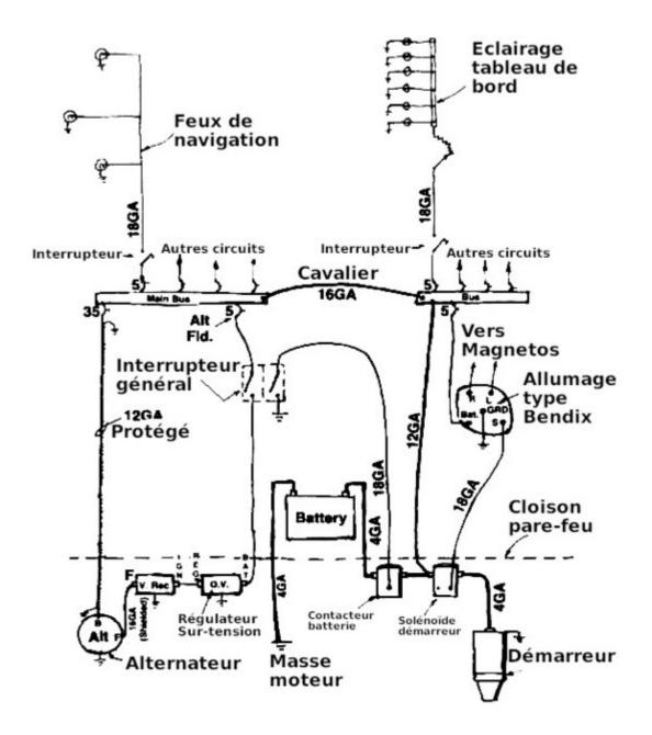
FIGURE 1 Schéma alternateur/Batterie/Démarreur
