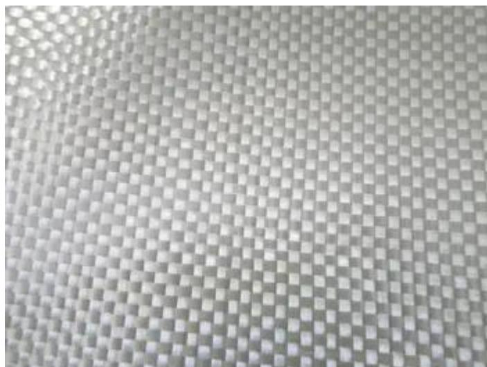
Le choix de l'épaisseur du roving dépendra des contraintes mécaniques auxquelles la pièce sera soumise. Les épaisseurs courantes sont le 300g/m<sup>2</sup>, le 500g/m<sup>2</sup> et le 800g/m<sup>2</sup>. L'utilisation de roving peut donc contribuer à améliorer les performances et la durabilité des pièces stratifiées.
