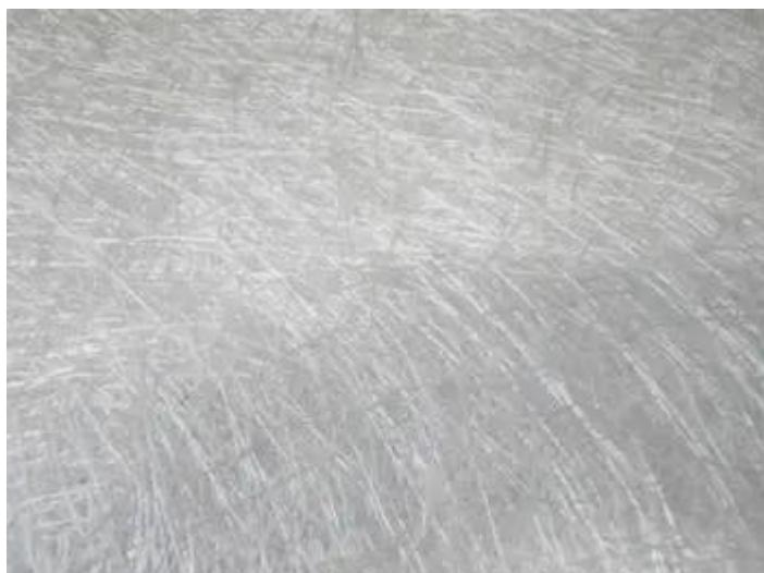
Dans le cas d'une stratification, il est important de préparer le support de travail en le nettoyant et en le séchant soigneusement. Le mat est ensuite découpé à la taille souhaitée et déposé sur le support préalablement imprégné d'une résine époxy, polyester ou vinylester. Il est ensuite de nouveau recouvert de résine et débullé. D'autres couches de mat de verre ou d'un autre renfort peuvent être superposées de la même manière pour renforcer la structure et atteindre l'épaisseur souhaitée.
