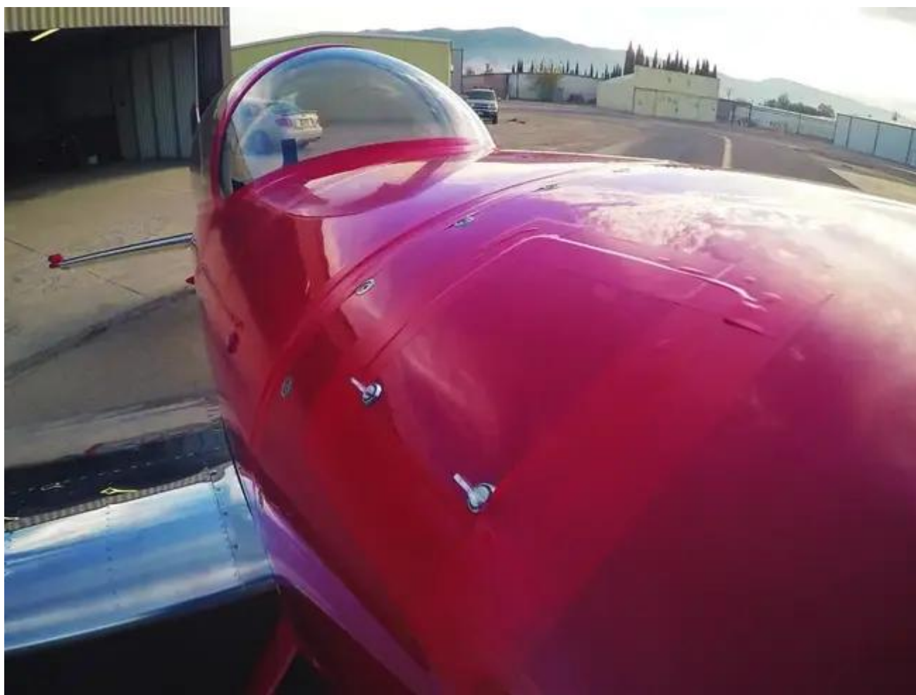
Porte d'accès du capotage et de la jauge de niveau d'hulle scellée avec du ruban vinyle.
