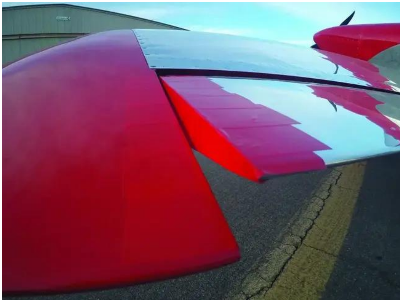
Du ruban vinyle rouge a été appliqué à l'extrémité extérieure de l'aileron et du saumon d'aile.
