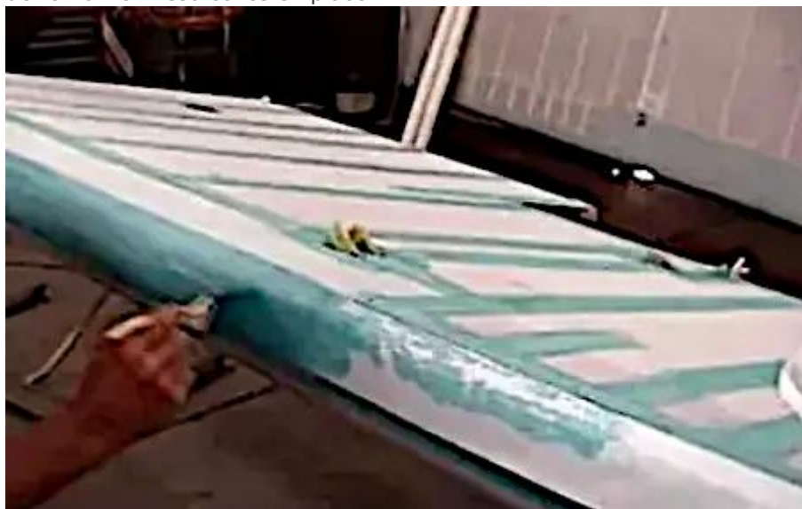
Figure 33. La colle est appliquée au pinceau à travers un ruban de quatre pouces lors de l'installation sur le joint du tissu au bord d'attaque d'une aile. Des rubans de deux pouces recouvrent les nervures d'aile et le laçage des nervures.
