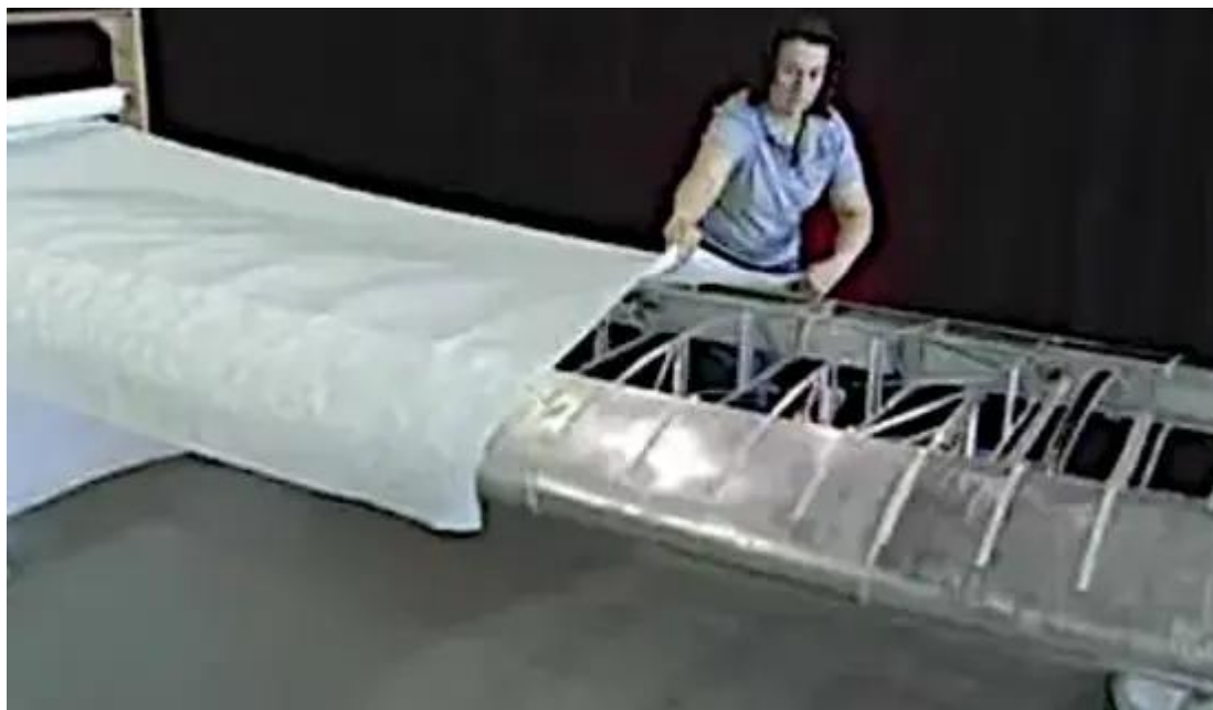
Figure 12. Mise en place du tissu lors d'un travail de recouvrement selon la méthode de la couverture.
