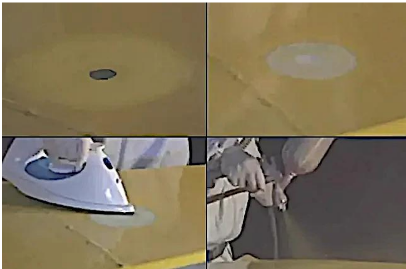
Figure 35. Une réparation par patch sur ce petit trou dans une couche de finition en polyuréthane est effectuée conformément aux instructions de réparation du STC avec lequel l'aéronef a été recouvert. Elle nécessite uniquement un chevauchement de tissu de deux pouces et un ponçage dans la couche de finition avant le collage et la remise en finition. D'autres instructions de réparation STC peuvent ne pas autoriser cette réparation.
