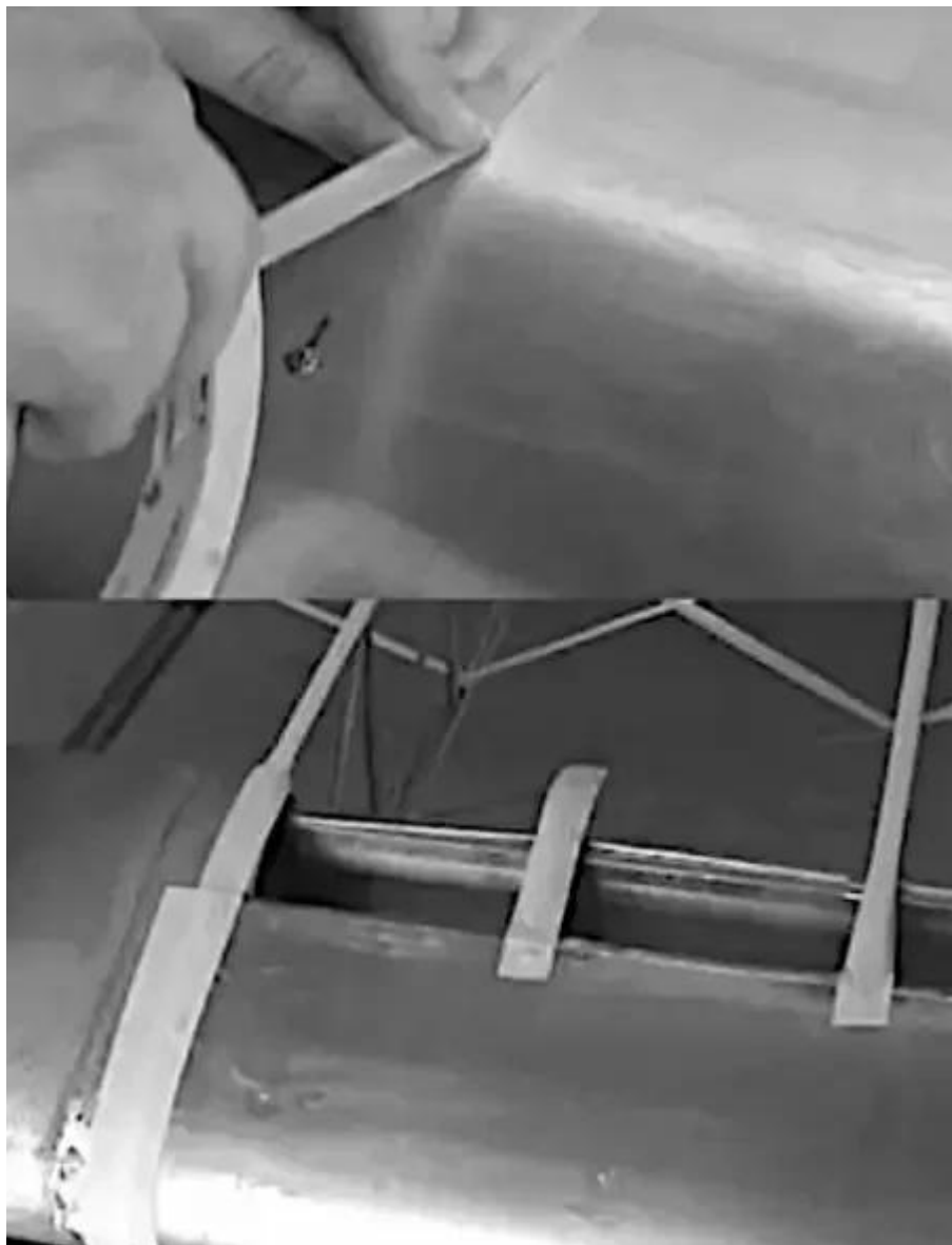
Figure 18. Un ruban anti-frottement est appliqué sur toutes les parties susceptibles de couper ou d'user le tissu.
