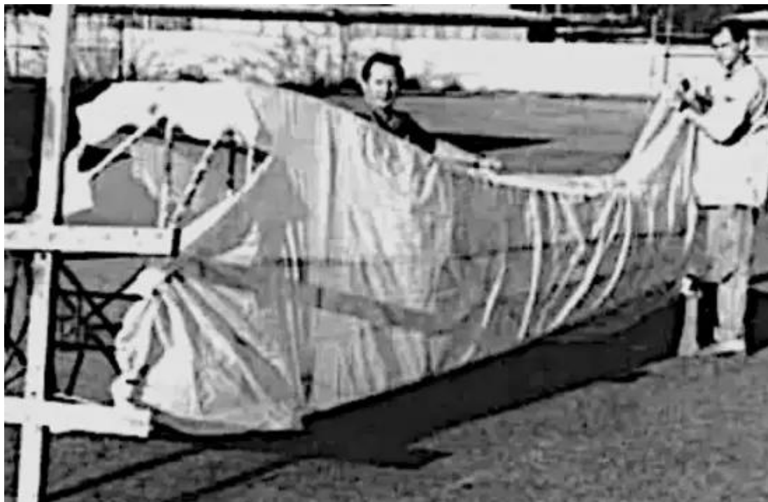
Figure 13. Une housse en tissu préassemblée sur mesure est glissée en position sur un fuselage pour la méthode de revêtement par enveloppe. À l'exception de l'ajustement, la plupart des étapes du processus de revêtement sont les mêmes que pour la méthode de revêtement par couverture.
