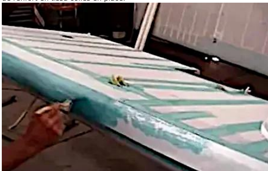
Figure 33. La colle est appliqué au pinceau à travers un ruban de quatre pouces lors de l'installation sur le joint du tissu au bord d'attaque d'une aile. Des rubans de deux pouces recouvrent les nervures d'aile et le laçage des nervures.
