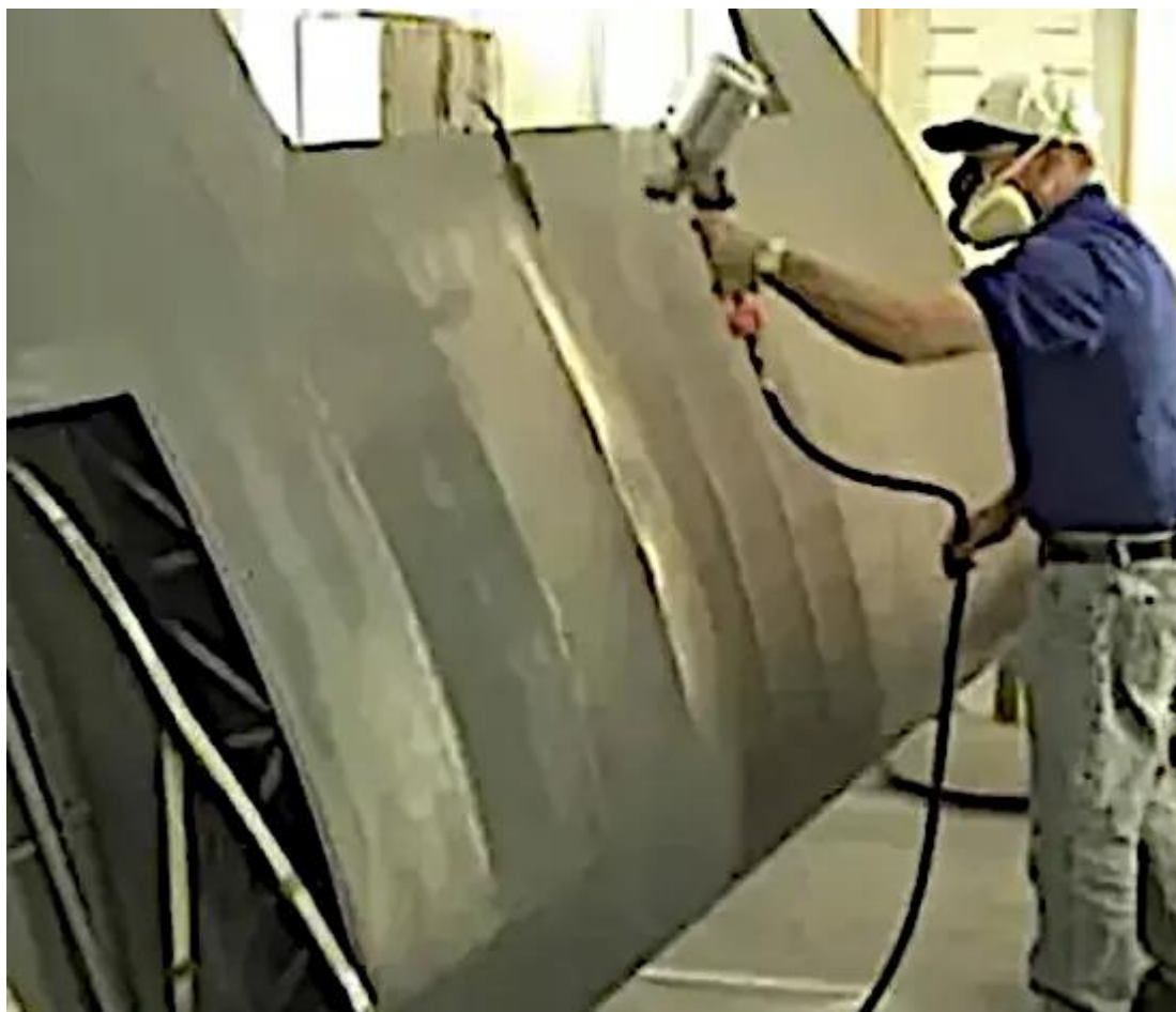
Figure 34. Application d'un apprêt avec protection UV en pulvérisant des couches croisées.
