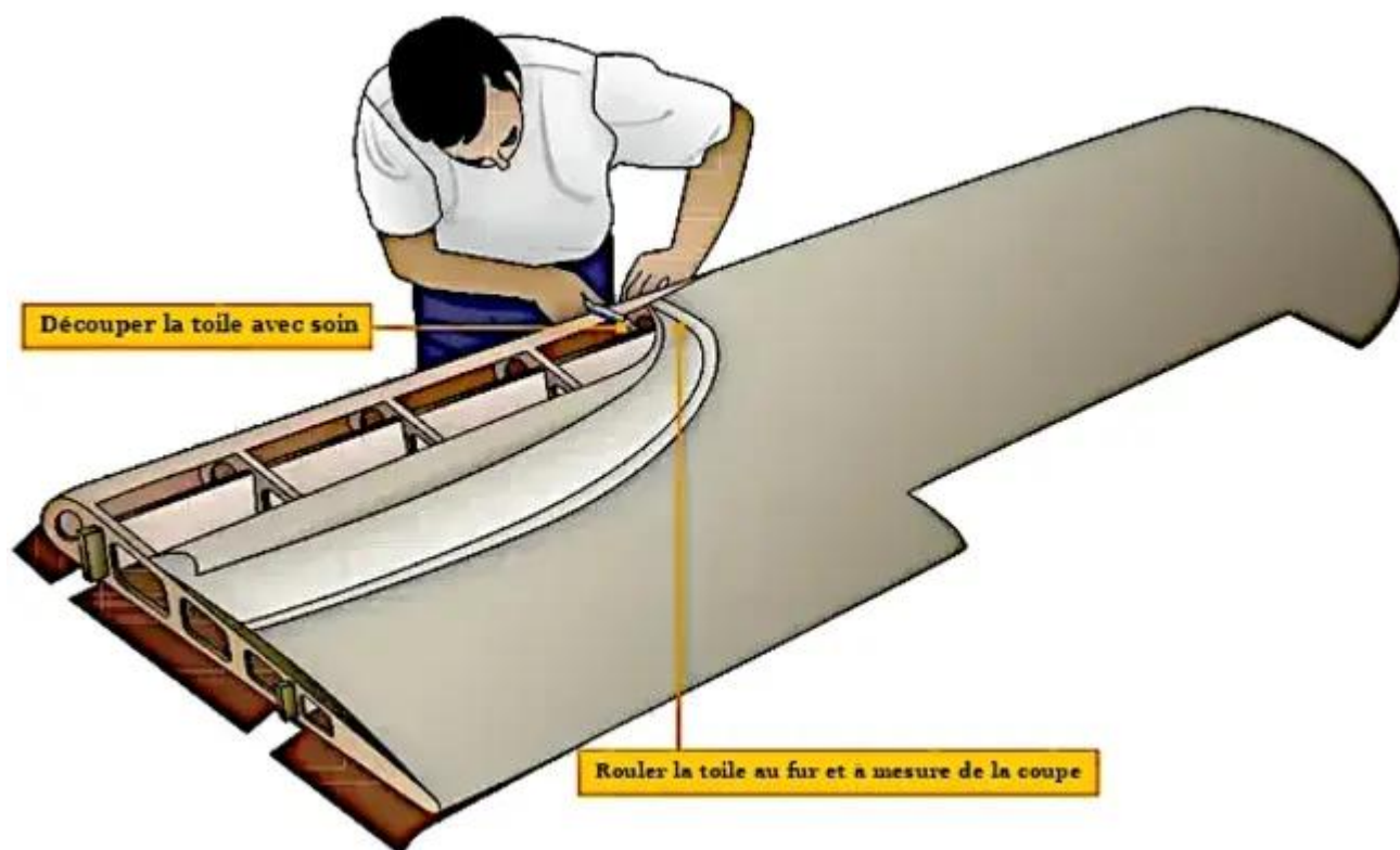
Figure 16. Les anciens revêtements en tissu sont découpés en grands morceaux afin de les conserver comme gabarits pour repérer les différentes caractéristiques de la cellule. Des lames tranchantes et de la prudence doivent être utilisées pour éviter d'endommager la structure.
