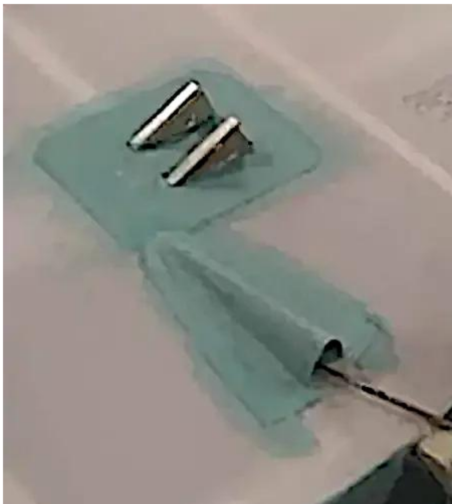
Figure 32. Un raccord de hauban et un guide de câble avec des goussets de renfort en tissu collés en place.
