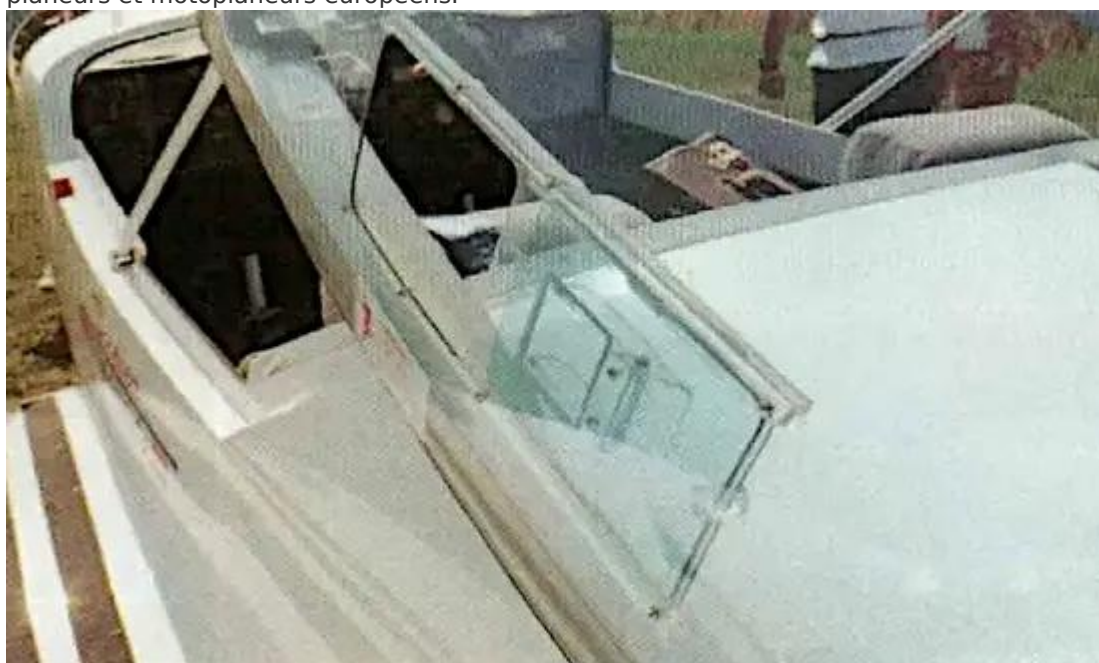
Voici un autre aérateur de fenêtre plus complexe, avec une prise d'air dynamique secondaire en plastique transparent intégrée dans le panneau coulissant en plexiglas.
