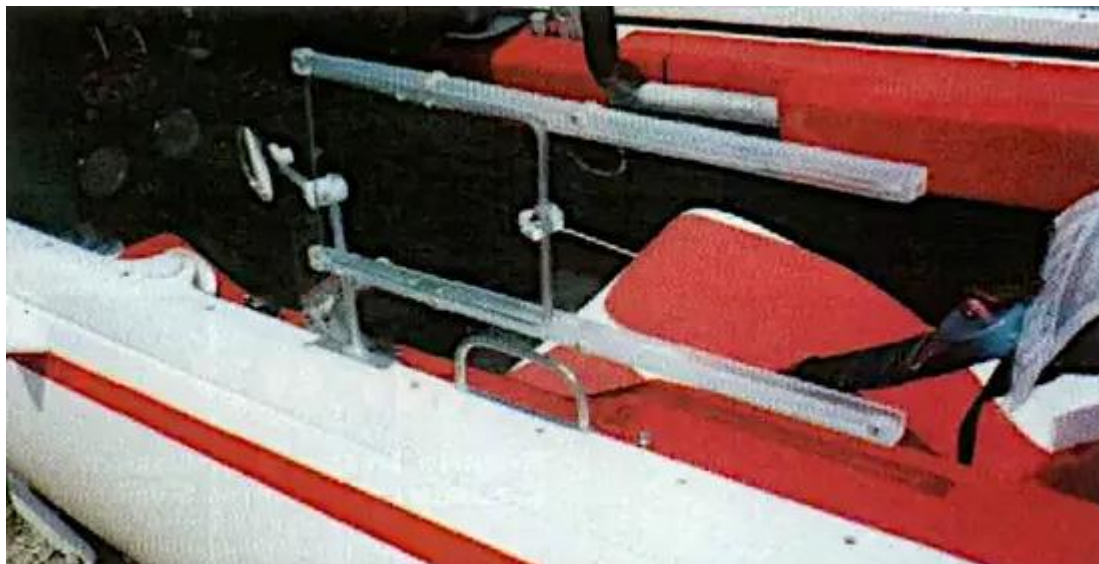
Une installation typique d'aérateur de fenêtre, telle qu'on peut en voir sur de nombreux planeurs et motoplaneurs européens.
