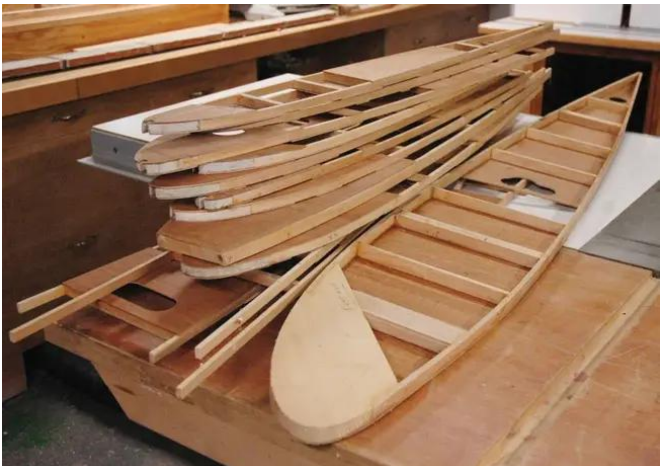
C'est la pile de 14 nervures pour l'aile droite, qui nécessite encore une paire de longerons, quelques interventions délicates, un revêtement, et une ou deux autres petites choses.
