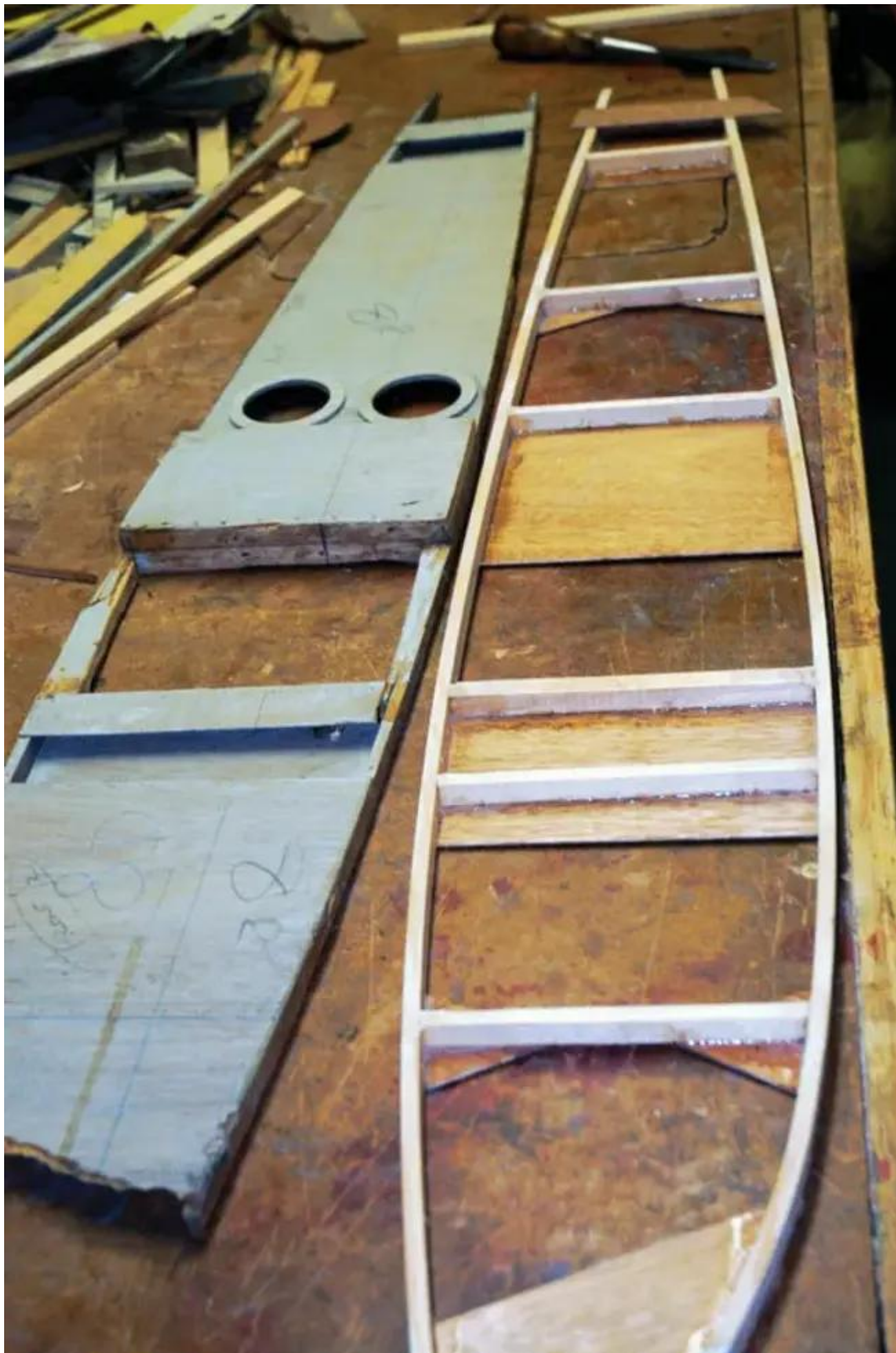
Une nouvelle nervure est montrée à côté de l'originale, dont le nez a été écrasé lors d'un atterrissage
