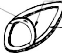
Forme supérieure annulaire en contreplaqué de 3/4" avec butée de hauteur
