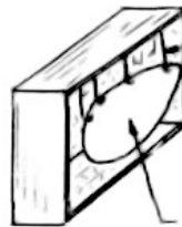
Boîte en contreplaqué renforcée par des angles en aluminium
