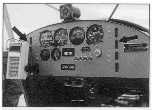
Tableau de bord VFR de base, dégagé, avec prévision pour un GPS portatif. Remarquez le traitement particulier des jauges de carburant visuelles gauche et droite.
