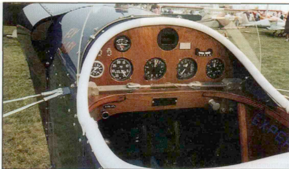
Ce Fly Baby est équipé d'un tableau de bord en contreplaqué de style spartiate, qui s'harmonise avec la finition vernie de la structure du fuselage.
