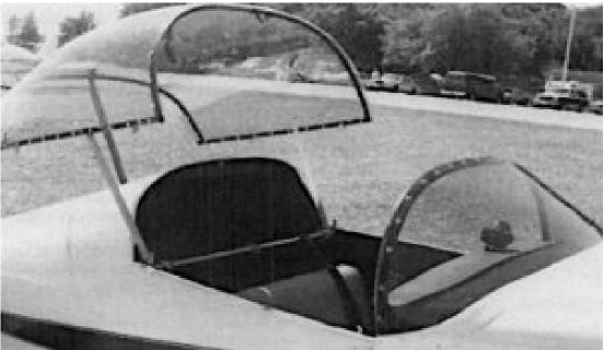
À l'exception de la bande de retenue à la base du pare-brise, le pare-brise et la verrière ont été installés sans aucune bande de finition... à l'européenne. Moins de traînée.
