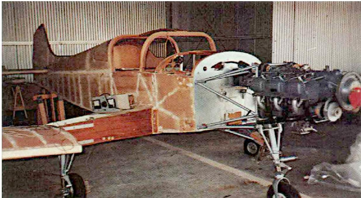
Le rapide Barracuda montre ses simples flancs plats de fuselage en contreplaqué prolongés par des contours aérodynamiques faits de formes en contreplaqué couvertes d'une peau en contreplaqué.
