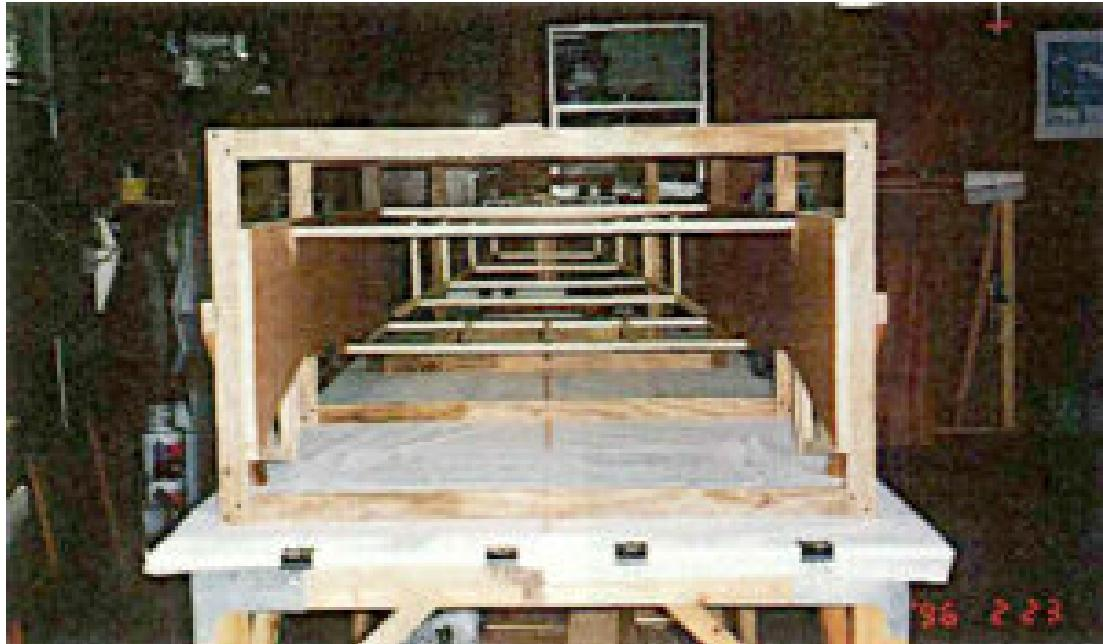
Cette photo de l'assemblage du fuselage montre la très importante ligne centrale tracée sur le plateau de l'établi. Chaque traverse, du pare-feu à l'étambot, est vérifiée à l'aide d'un fil à plomb pour s'assurer que sa ligne centrale est parfaitement alignée sur la ligne de référence de l'établi.
