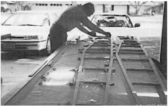
La première étape de la construction d'un fuselage en bois est la fabrication des deux côtés. Le montage de droite a été retiré du gabarit et attend d'être recouvert de contreplaqué. Rappelez-vous qu'il faut un côté gauche et un côté droit au moment de la pose du contreplaqué.
