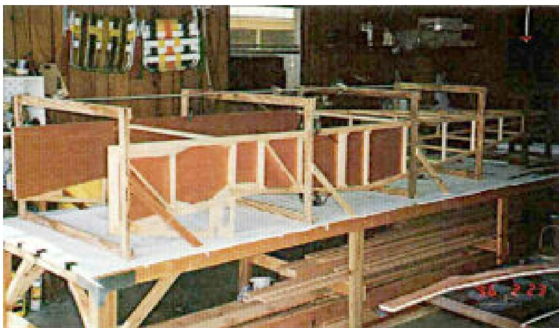
Un fuselage de GP-4 en cours d'assemblage. Montage un peu inhabituel car les côtés du fuselage sont dressés dans un gabarit pour l'assemblage. Les deux côtés sont clampés temporairement dans des formes en contreplaqué pour assurer un alignement parfait
