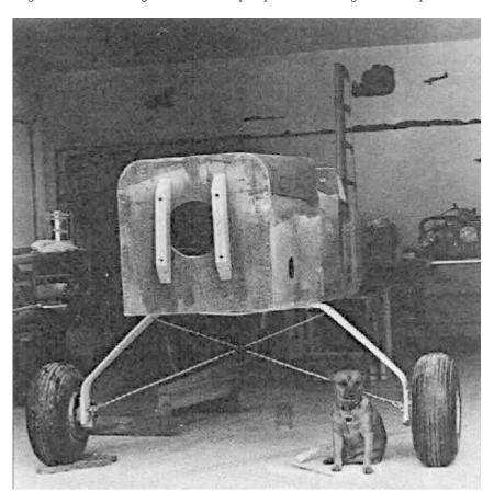
Le pare-feu du VP-1 dans sa grande simplicité. Le contreplaqué est revouvert d'une couche d'amiante et d'une feuille de métal galvanisé. Comme visible ici, le bati moteur n'est rien de plus que deux blocs de frêne sur lesquels le moteur est boulonné. Et le gros trou ? Il permet le passage de la magnéto protubérante et sera recouvert d'un bol en acier inox afin d'assurer l'étanchéïté du pare-feu.
