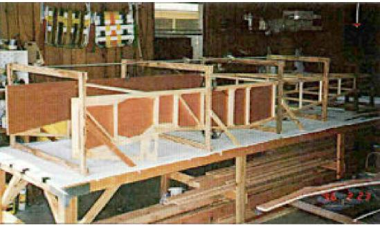
Un fuselage de GP-4 en cours d'assemblage. Montage un peu inhabituel car les côtés du fuselage sont dressés dans un gabarit pour l'assemblage. Les deux côtés sont clampés temporairement dans des formes en contreplaqué pour assuré un alignement parfait durant la construction. Le constructeur est maintenant prêt à découper et ajuster les montants.
