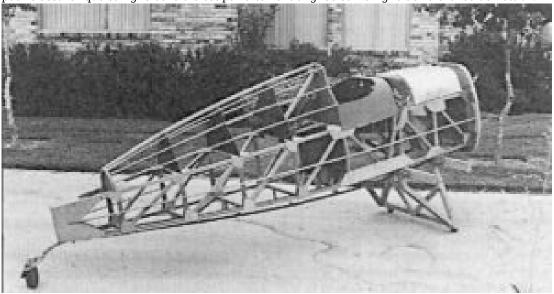
Fuselage d'un biplan Jungster, une robuste beauté bois et toile. L'alignement des lisses et des baguettes de carénage est extrêment important car elles sont visibles sous l'entoilage.
