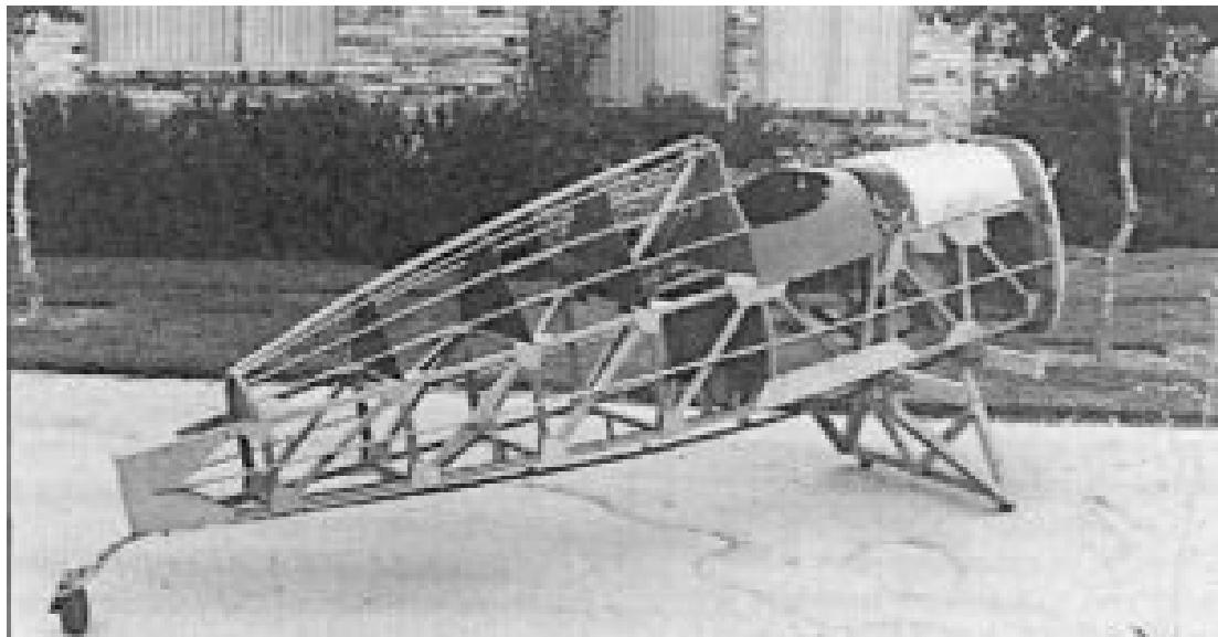
Fuselage d'un biplan Jungster, une robuste beauté bois et toile. L'alignement des lisses et des baguettes de carénage est extrêmement important car elles sont visibles sous l'entoilage.
