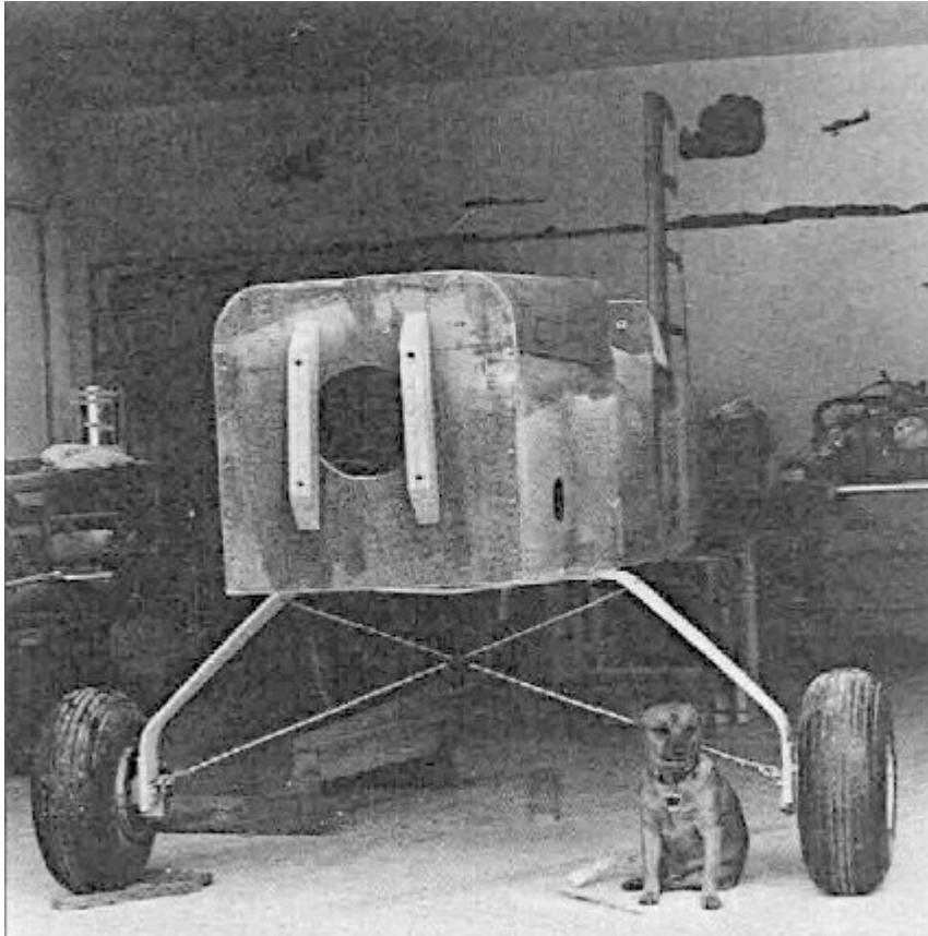
Le pare-feu du VP-1 dans sa grande simplicité. Le contreplaqué est revouvert d'une couche d'amiante et d'une feuille de métal galvanisé. Comme visible ici, le bati moteur n'est rien de plus que deux blocs de frêne sur lesquels le moteur est boulonné. Et le gros trou ? Il permet le passage de la magnéto protubérante et sera recouvert d'un bol en acier inox afin d'assurer l'étanchéité du pare-feu.
