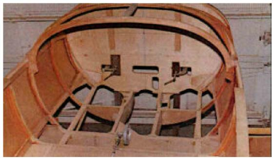
La complexité du superbe fuselage en bois du Falco est visible ici. La construction, les gabarits et l'alignement de ce type de fuselage sont beaucoup plus difficiles à réaliser que les fuselages à flancs plats.
