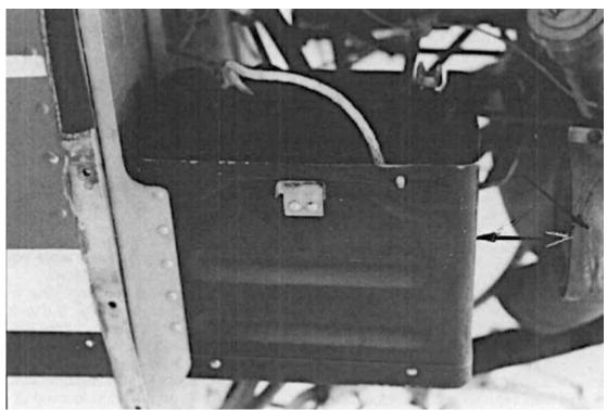
La flèche indique la proximité du système d'échappement . . . un gros producteur de chaleur. Une batterie située dans le compartiment moteur peut souffrir d'une durée de service raccourcie. Ni les batteries à cellule humide ni les batteries gélifiées ne tolèrent très bien la chaleur.
