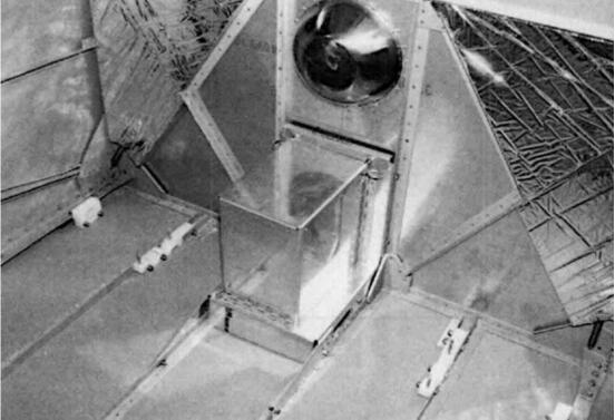
Ce compartiment batterie en métal abritera une batterie électrolyte gélifiée scellée. Remarquez que l'emplacement est dans la zone de la cabine, collé à la cloison pare-feu.
