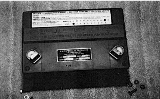
Une batterie à électrolyte gélifiée typique. L'absence de bouchons de remplissage pour les cellules individuelles est un indice que la batterie est scellée et sans entretien. Remarquez les bornes en forme de "L" . . . une caractéristique reconnaissable de toutes les batteries de type aéronef à
