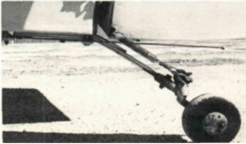
Une installation classique. Le ressort est légèrement pré-tendu et l'excédent de ressort est coupé.
