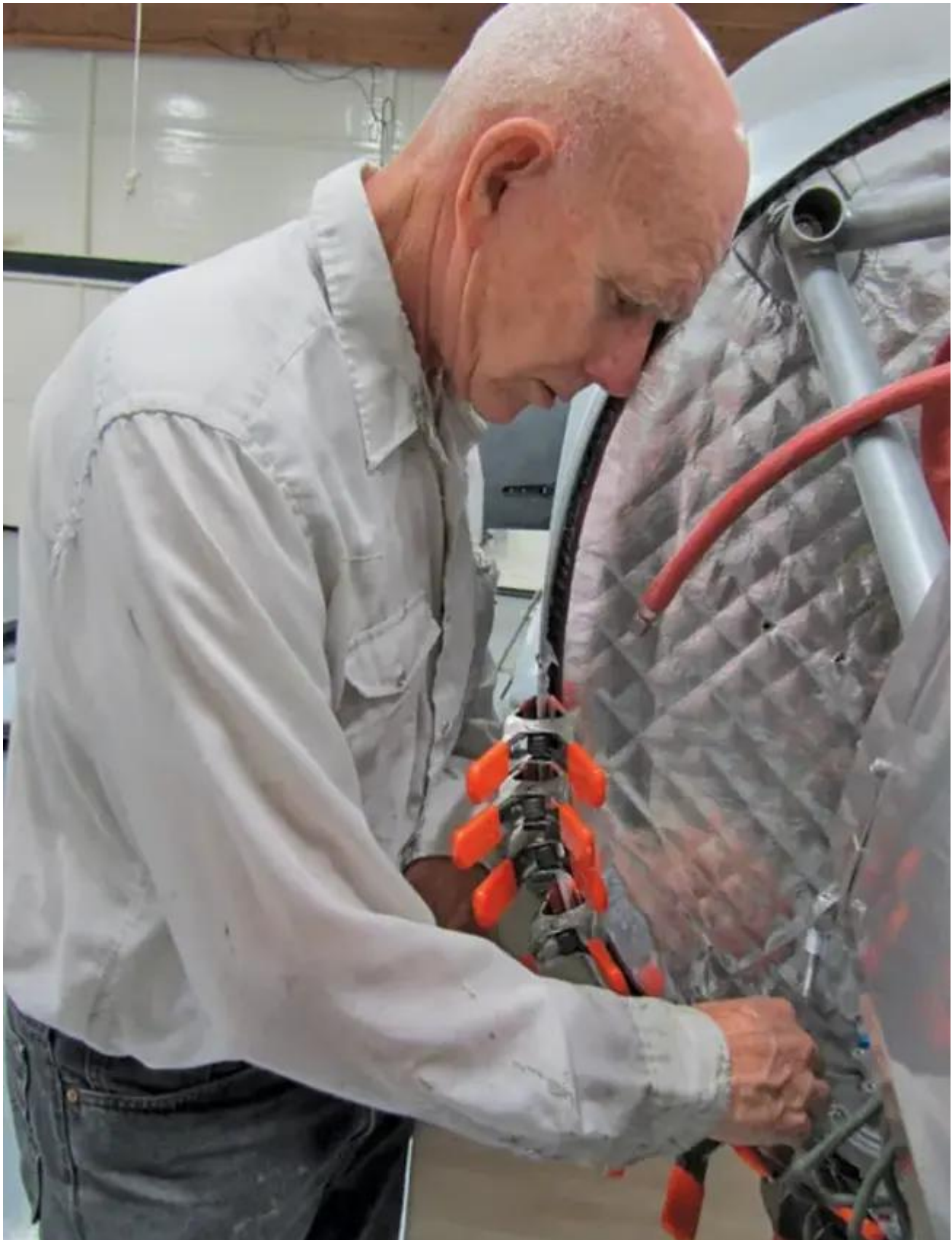
Installation du moteur dans un Lancair Evolution. Notez la couverture de pare-feu fournie par l'usine, fabriquée pour protéger la structure composite de l'avion.
