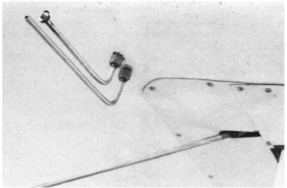
Un bon emplacement pour la tête pitot-statique. Celle-ci se trouve sous l'aile supérieure d'un biplan. Remarquez le petit anneau permettant d'ajuster la pression statique.
