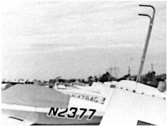
Qui a dit que les têtes pitot-statiques devaient être dans l'aile ? Celle-ci, perchée, est sur un T-18.
