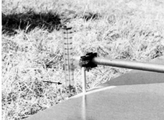
Ce gadget ressemblant à un tube à essais est en réalité un indicateur de vitesse sur un ultraléger. Un léger bouchon en mousse ou une balle de ping-pong se déplace sous la pression d'air dynamique entrant à l'endroit indiqué par la flèche.
