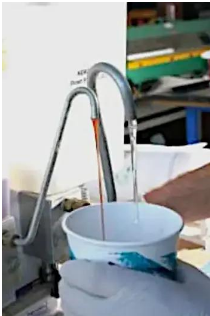
À l'aide d'une pompe spécialisée, proportions exactes de résine et de durcisseur nécessaires au travail.
