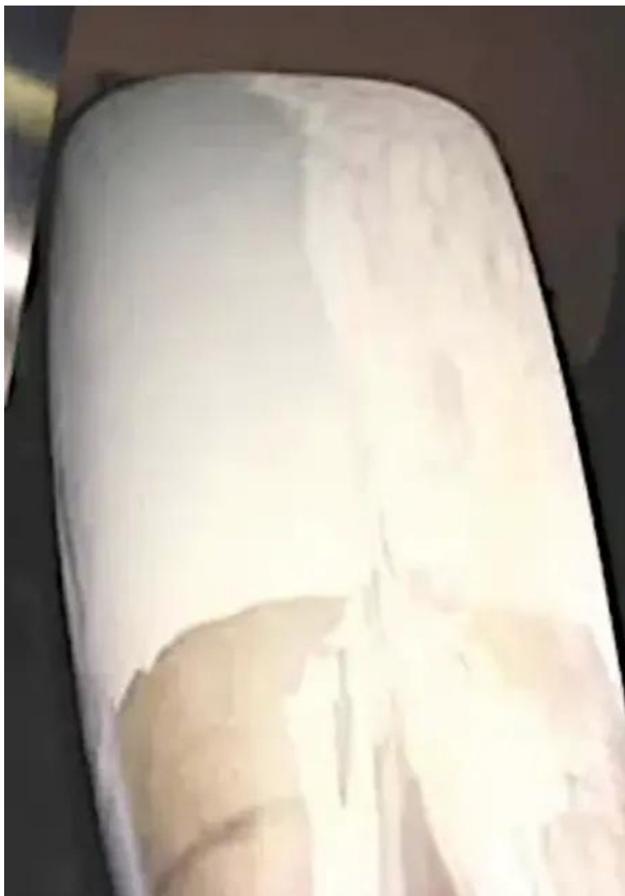
Le côté gauche du fuselage de ce Pulsar a reçu une épaisse couche d'apprêt garnissant appliquée au rouleau ; le côté droit montre les
