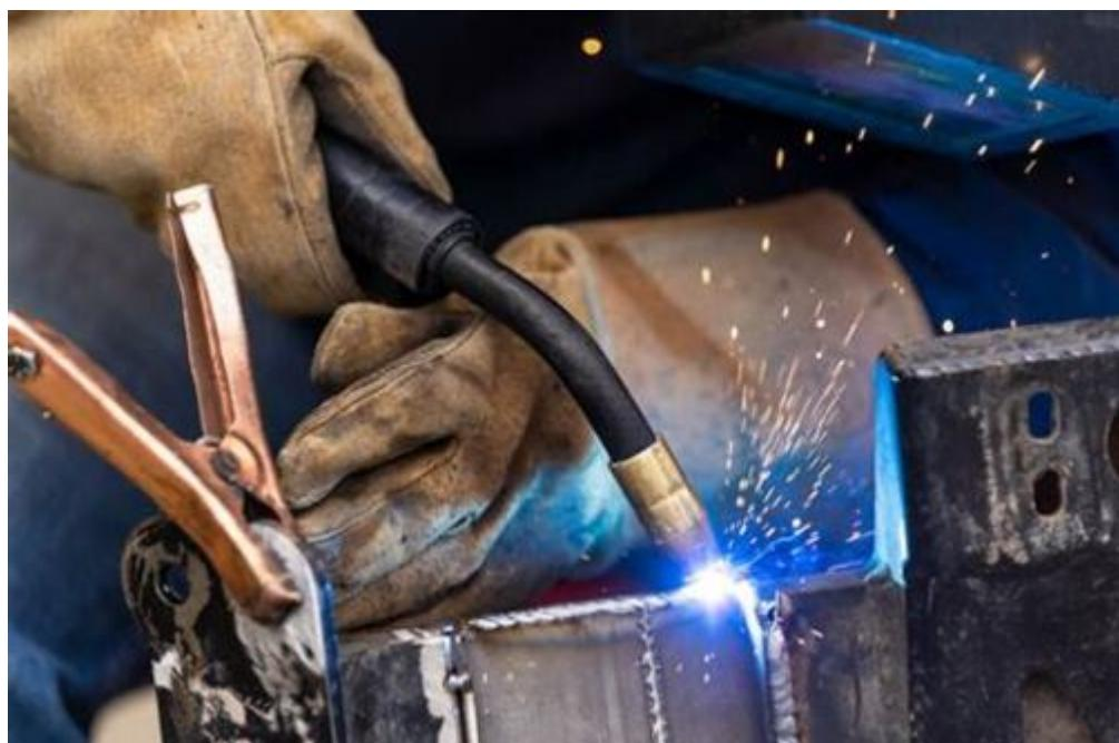
Beaucoup de fabricants de kits utilisent la soudure au MIG dans la construction des cellules de leurs avions car la rapidité de ces soudures est un facteur déterminant de prix de revient. Certains indiquent qu'ils relâchent les tensions du métal sur certaines pièces spécifiques, alors que d'autres ne font aucune opération particulière après soudure.
