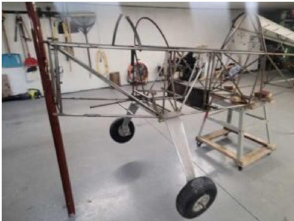
Avant que les composites ne prennent le pas sur tous les autres modes de construction amateur, les structures en tubes soudés étaient de loin les plus populaires et personne n'avait peur de souder. Pourtant, à cette époque, lorsque on parlait de soudure, il ne s'agissait que d'un seul type de soudure, le procédé oxy-acétylène ... la soudure au chalumeau à l'ancienne mode.
