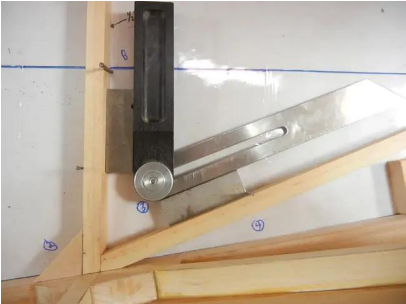
Les bases de deux équerres de mécanicien décalent le rapporteur ajustable du gabarit de clouage.
