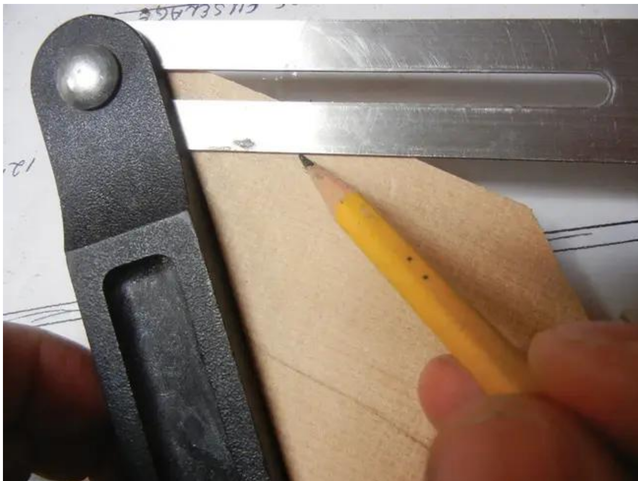
Traçage à l'aide du rapporteur ajustable.
