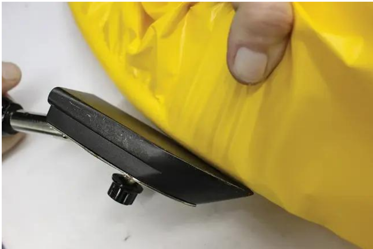
Fig. 6 : Sur les sections courbes, tirez le tissu d'une main tout en le repassant avec l'autre.
