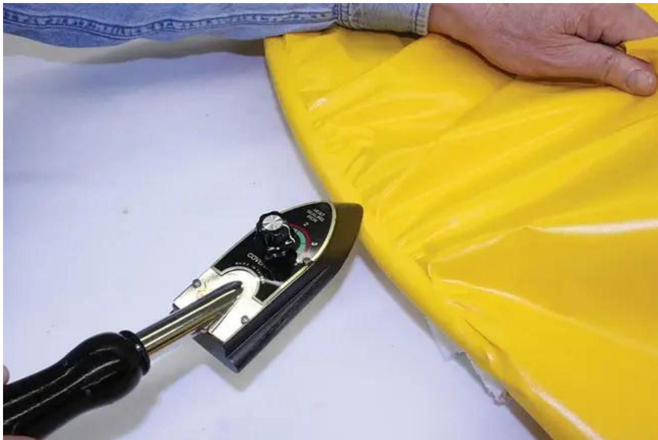
Fig. 7 : Avec un peu d'effort et de chaleur, le tissu peut être enroulé autour de formes complexes sans faire de plis.
