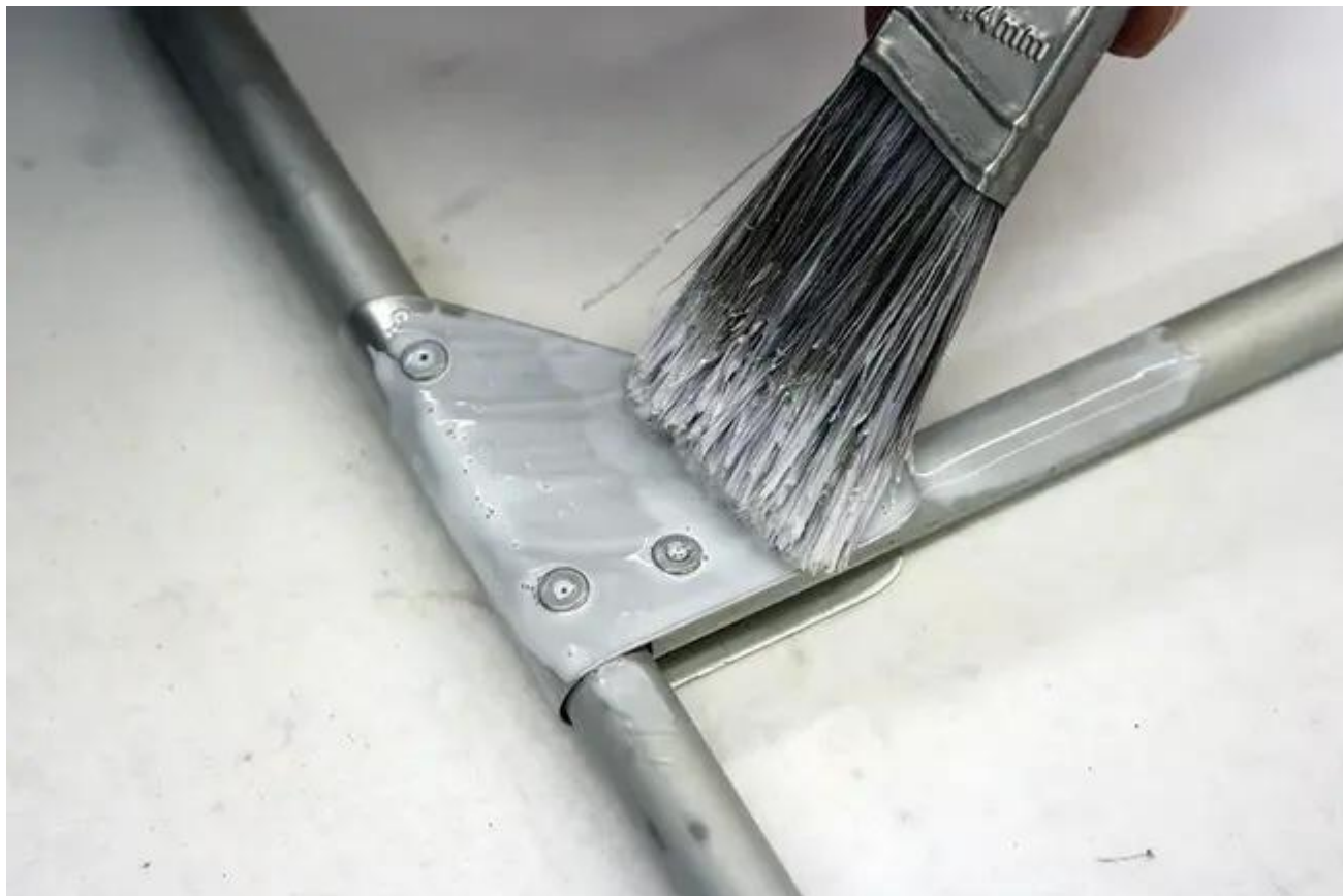
Fig. 1 : Après un nettoyage approfondi, éraflez les pièces à recouvrir avec un abrasif doux, puis appliquez l'adhésif Oratex avec un pinceau.
