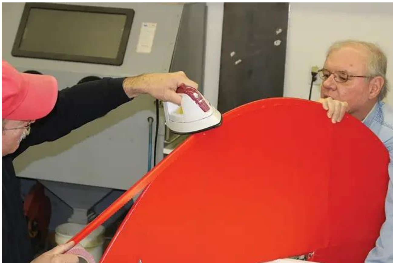
Fig. 8 : L'application du tissu sur un périmètre courbe se fait mieux à deux personnes. Une maintient le panneau en place pendant que l'autre tire et repasse le tissu.
