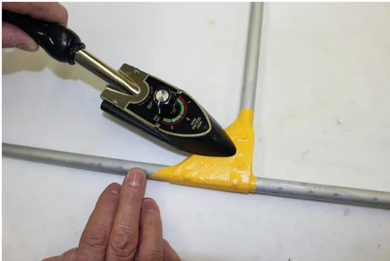
Fig. 3 : Découpez une pièce de tissu enduit d'adhésif environ 1/4" plus grande que l'objet à recouvrir et repassez-la en place.
