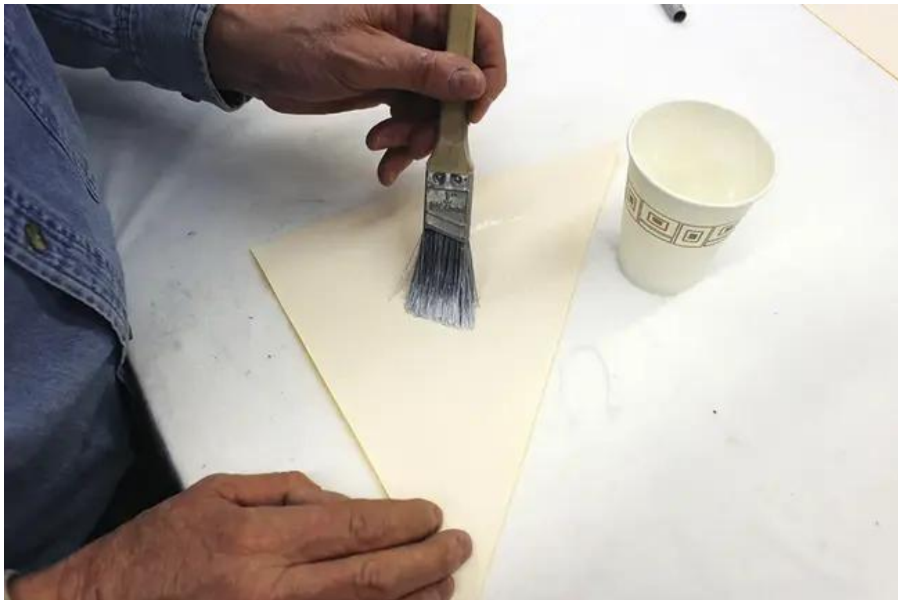
Fig. 2 : En plus des pièces à recouvrir, l'adhésif Oratex doit également être appliqué sur l'envers du tissu.
