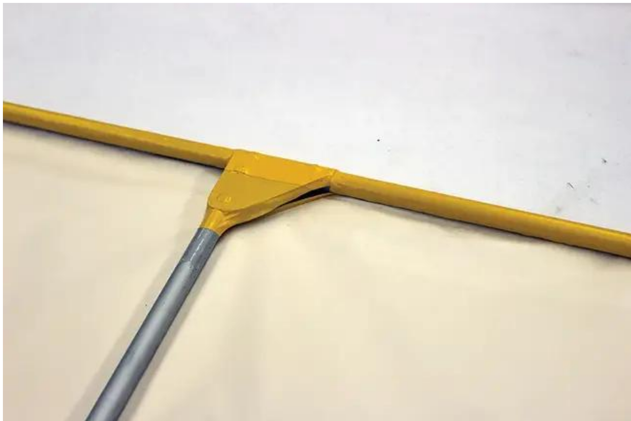
Fig. 5 : Voici à quoi ressemble une section terminée ; il est important d'aller lentement, d'appliquer une pression sur le fer et de chauffer chaque pouce carré.
