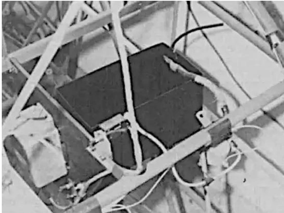
Cette batterie est profondément enfouie dans le fuselage, ce qui rend l'accès et l'entretien difficiles. Le boîtier doit être très bien ventilé, sinon les vapeurs de la batterie risquent de corroder la structure et les câbles de commande.
