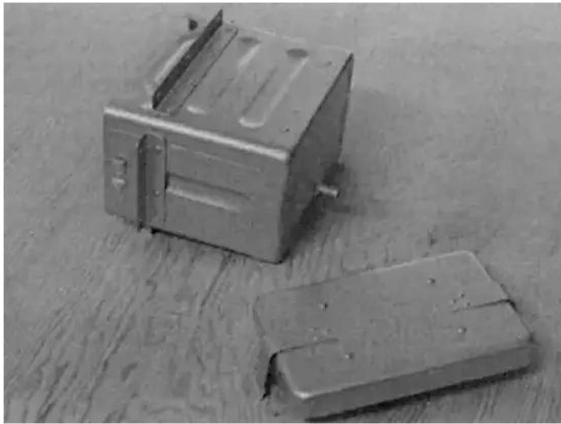
La boîte de la batterie a été modifiée afin qu'elle puisse être partiellement encastrée dans le plancher du compartiment de la batterie. Cette modification améliore l'accessibilité et permet d'entretenir plus facilement les cellules en ajoutant de l'eau au besoin.
