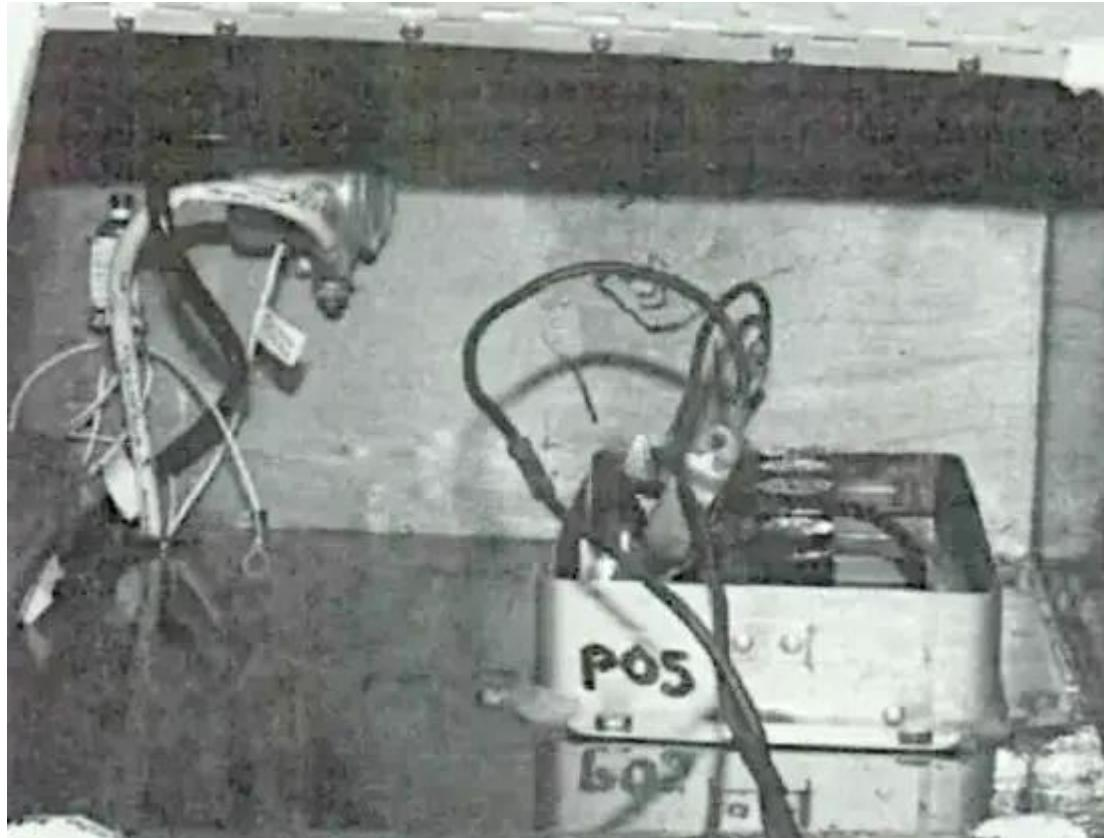
La même boîte de batterie est encastrée dans le plancher du compartiment de la batterie. La facilité d'accès est évidente. Les fils proviennent d'un chargeur de batterie qui donne un coup de charge à la nouvelle batterie au plomb "chargée à sec" afin de la charger complètement.
