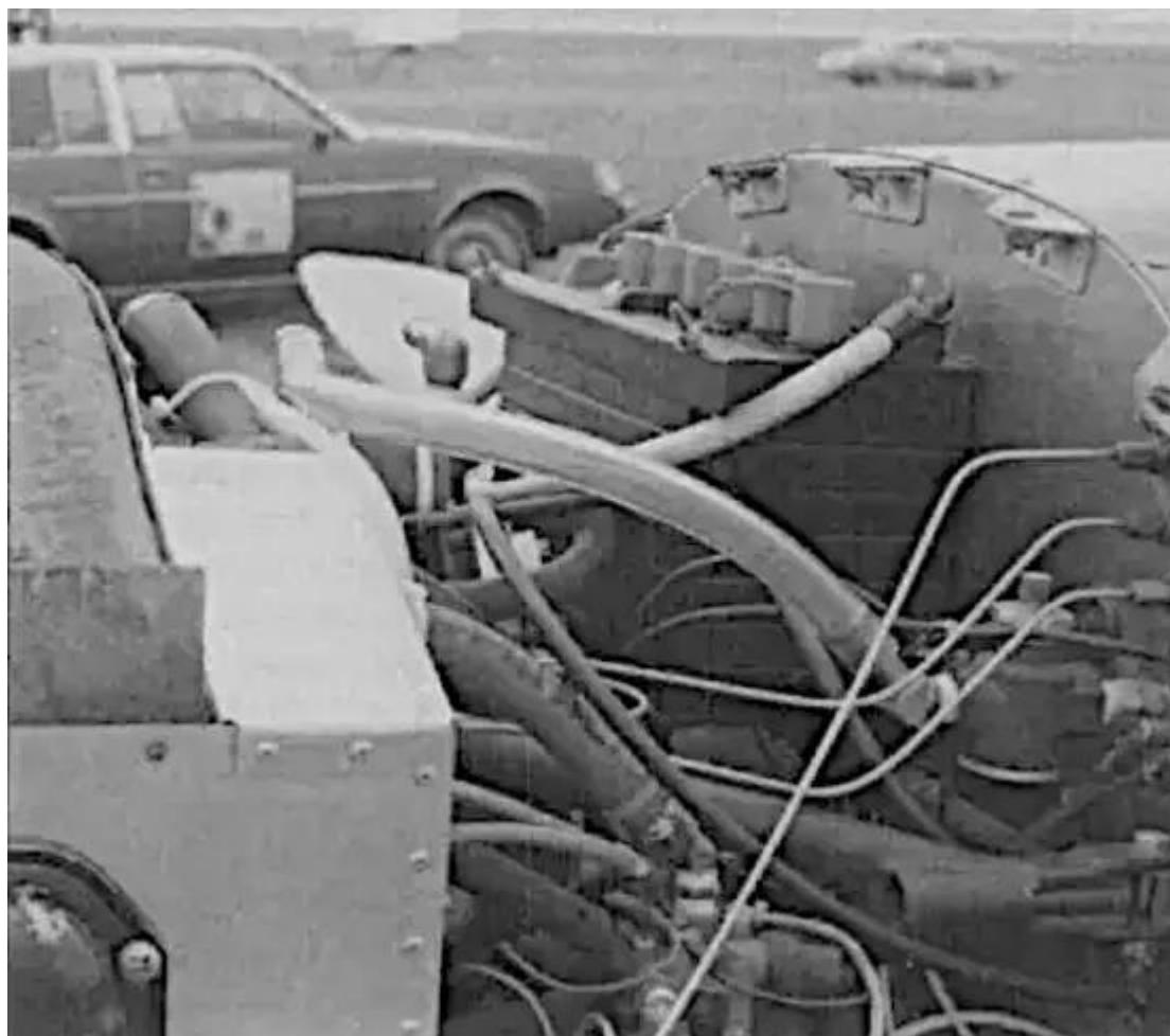
L'emplacement en hauteur sur la cloison pare-feu éloigne la batterie de la majeure partie de la chaleur directe du moteur. Cependant, une boîte de batterie doit toujours être utilisée avec une batterie au plomb.
