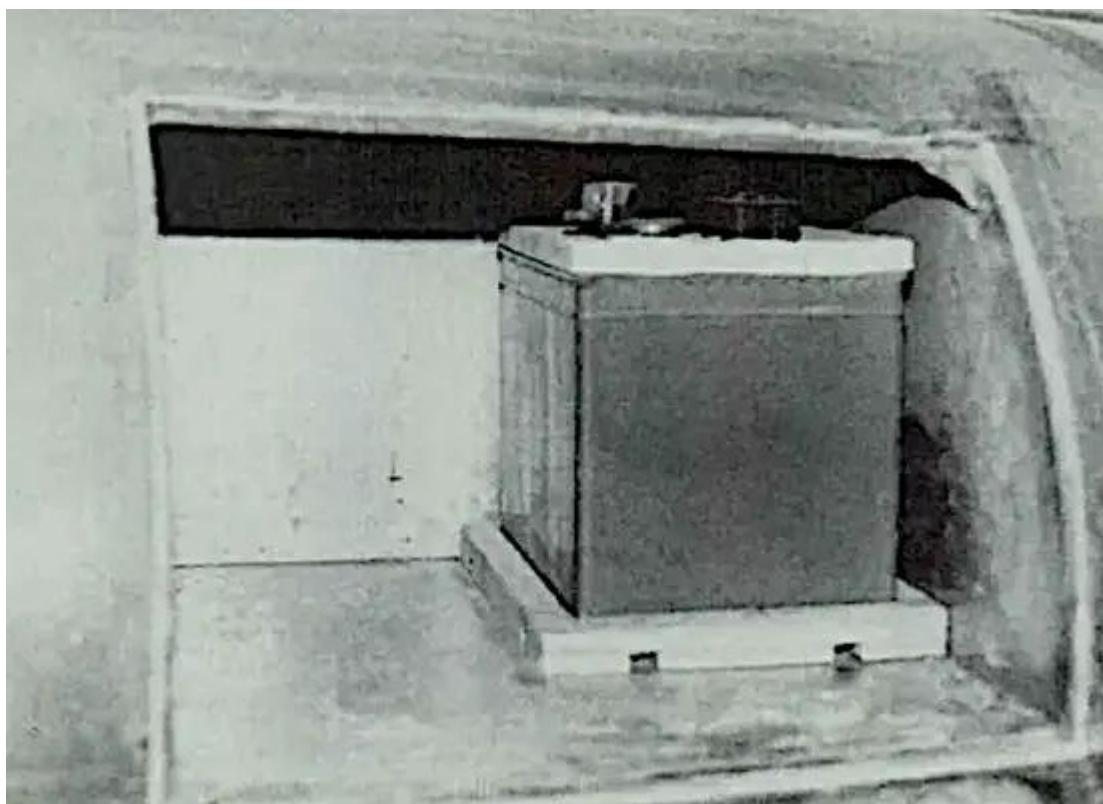
Installation d'une batterie Gel/Cell. Notez que, si c'était une batterie au plomb, il serait très difficile de la contrôler et de l'entretenir avec de l'eau. Il faudrait retirer la batterie pour pouvoir le faire.
