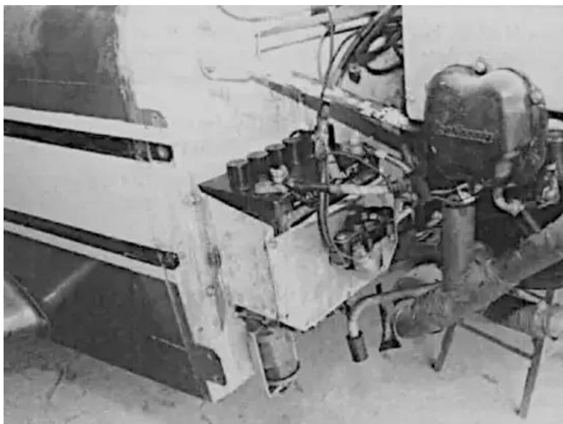
Cet emplacement sur la cloison pare-feu est pratique pour le propriétaire, mais néfaste pour la batterie en raison de la proximité des tuyaux d'échappement chauds. L'absence de couvercle de la boîte de batterie expose le support moteur, la cloison pare-feu et les zones adjacentes aux effets corrosifs des vapeurs d'acide de la batterie.
