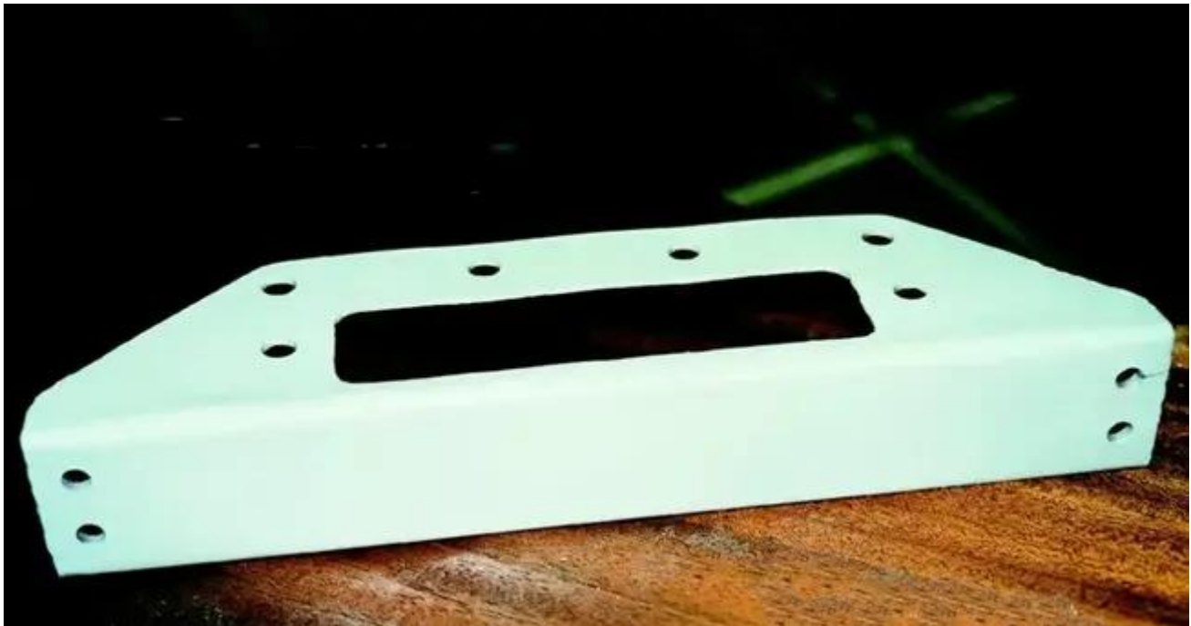
Une fixation d'aile, prête après application d'apprêt
