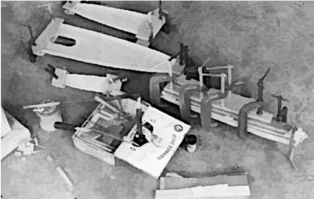
Plusieurs nervures en cours d'encollage des goussets. Notez que de nombreux serre-joints sont nécessaires.
