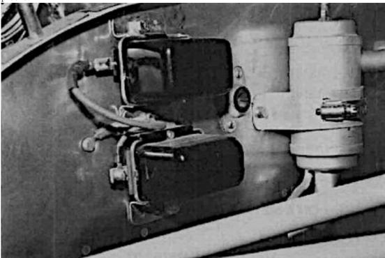
Le régulateur de tension et le relais de surtension doivent être mis à la terre même si votre schéma de câblage ne l'indique pas. Sans une bonne mise à la terre, ni le régulateur de tension ni le relais de surtension ne peu fonctionner.
