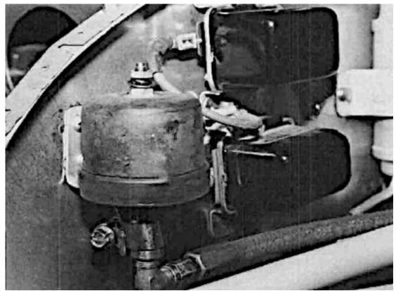
Les capteurs électriques (tels que les capteurs de pression d'huile et de pression de carburant) ayant de mauvaises mise à la masse donneront de fausses lectures basses. Un capteur de pression d'huile est représenté ici. »
