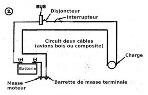
FIGURE 1 Circuits électriques de base
