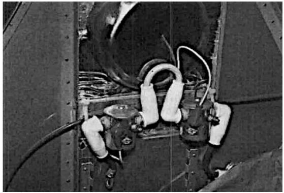
Le solénoïde de batterie et le solénoïde de démarreur représentés ici sont automatiquement mis à la terre par leurs boîtiers. Lorsque les équipements sont montées sur une surface autre qu'une surface métallique à la masse, des connecteurs de mise à la masse séparés doivent être installés jusqu'au point de mise à la masse le plus proche.
