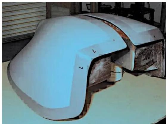
Le moule a également été séparé en deux dans le sens de la longueur afin que la verrière puisse être formée en deux parties. Nous avons appliqué une couche d'apprêt gris foncé sur le rebord de serrage afin de ne pas perdre notre ligne de repère pour la découpe ultérieure de l'acrylique.
