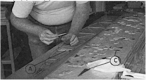
La nervure d'aile (A) vient d'être retirée du gabarit (B), retournée, et de la colle est appliquée afin que les goussets (C) puissent être fixés sur l'autre face de la nervure. Remarquez que la planche du gabarit est protégée (contre les débordements de colle) par du papier ciré ou du polyéthylène.
