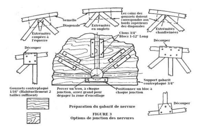
Faites de votre première assemblage de nervure un prototype ou nervure maître en chargeant le gabarit avec toutes les pièces ajustées et assemblées sans colle. Numérotez chaque diagonale et montant dans le gabarit avec votre fidèle stylo Sharpie. Commencez par l'avant de la nervure et marquez également le même numéro à côté de chaque emplacement de montant ou diagonale dans le gabarit.
