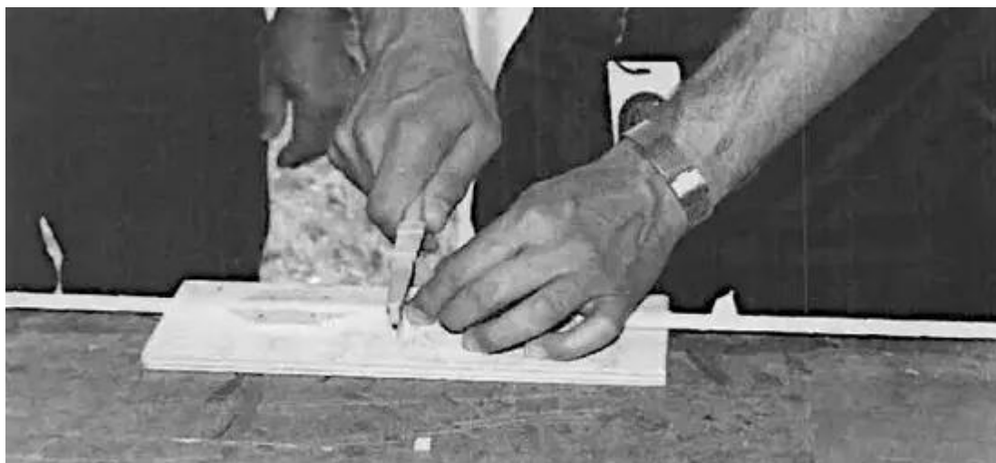
Ce constructeur utilise une scie de maquettiste pour couper le matériau de la baguette de semelle. Un simple gabarit en contreplaqué maintient la pièce solidement pendant la coupe.
