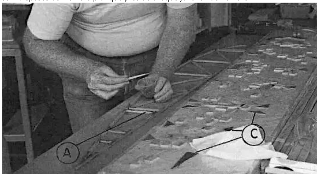
La nervure d'aile (A) vient d'être retirée du gabarit (B), retournée, et de la colle est
