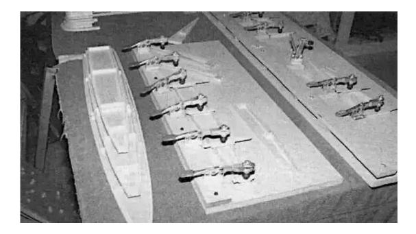
Ce constructeur a choisi de serrer ses goussets de nervure à l'aide de serre-joints plutôt que de les clouer ou de les agrafer. Des serre-joints à levier, fixés sur l'établi, sont pré-réglés pour exercer la pression de serrage souhaitée.
