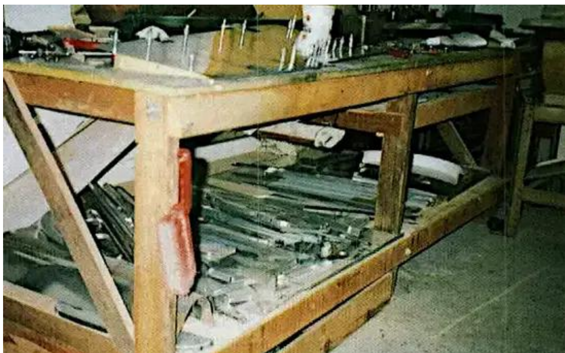
Ce grand établi d'assemblage est constitué d'une seule plaque de contreplaqué. Les espaces de rangement situés en dessous sont extrêmement pratiques et facilement accessibles.
