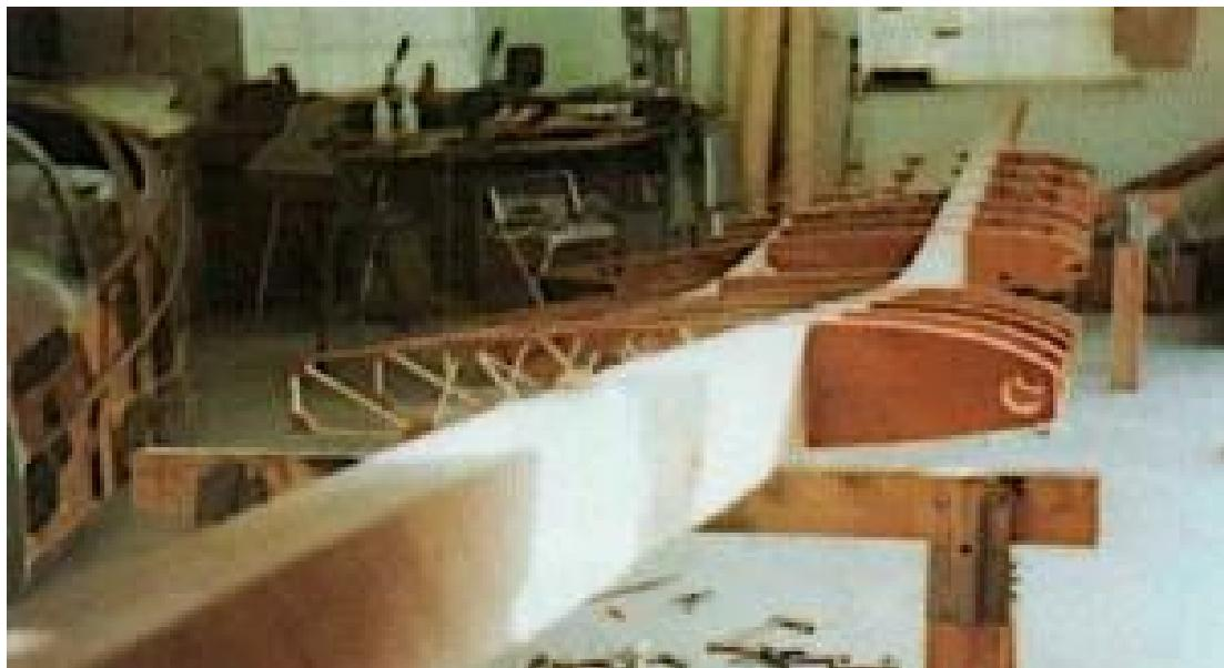
Si votre projet comporte une aile cantilever en une seule pièce, il pourrait être judicieux de terminer d'abord les surfaces de queue et le fuselage. Ce constructeur a dû ramper sous l'aile des centaines de fois pour passer d'un côté à l'autre. L'outil dont il avait besoin se trouvait toujours de l'autre côté.
