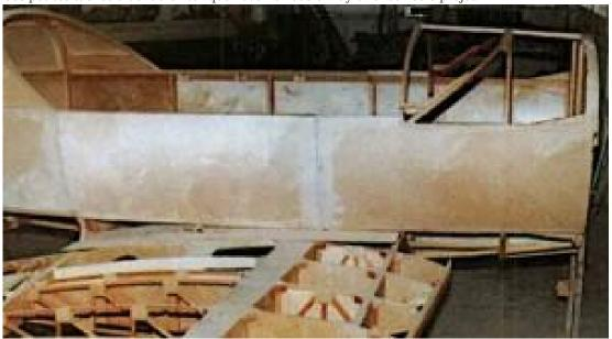
Même lorsque l'aile et le fuselage doivent être construits en un seul ensemble intégré, il est plus pratique de terminer d'abord la majeure partie de la construction du fuselage.
