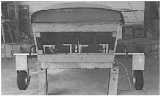
Laisser la cloison pare-feu ouverte sur ce projet KR a permis au constructeur de commencer à travailler sur l'installation du gouvernail et du train d'atterrissage tout en bénéficiant d'un accès facile.
