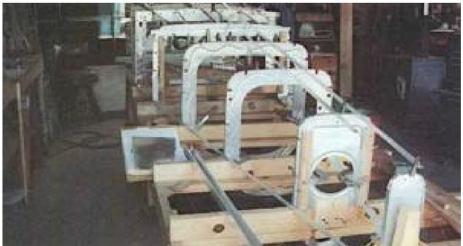
La construction d'un fuselage RV (RV-4, RV-6, etc.) nécessite l'utilisation d'un grand gabarit lourd d'environ 14 pieds de long. Il restera en place pendant toute la durée de vos travaux sur cette structure.
