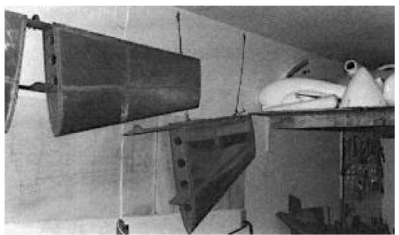
Les surfaces de queue sont petites et relativement faciles à construire. Une fois terminées, elles peuvent être suspendues pour ne pas gêner, libérant ainsi l'atelier pour la construction des structures plus grandes des ailes et du fuselage.
