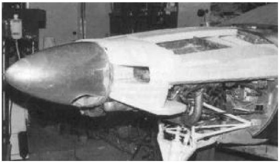
Il est prudent d'installer le moteur avant de tenter de construire le capot moteur.
