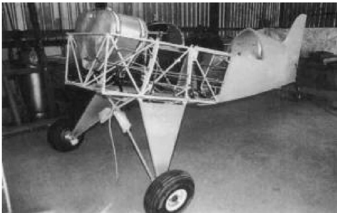
Ce petit biplan est construit entièrement à partir de plans. Bien qu'une grande quantité de travail soit à prévoir, le modèle est d'un type très pratique pour le constructeur amateur. Il peut être construit dans un simple garage pour voiture, dans n'importe quel ordre, car les ailes et l'empennage sont tous des ensembles séparés relativement petits. Avec le train d'atterrissement fixé au fuselage, la mobilité dans l'atelier est assurée dès le début du projet.
