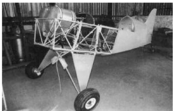
Ce petit biplan est construit entièrement à partir de plans. Bien qu'une grande quantité de travail soit à prévoir, le modèle est d'un type très pratique pour le constructeur amateur. Il peut être construit dans un simple garage pour voiture, dans n'importe quel ordre, car les ailes et l'empennage sont tous des ensembles séparés relativement petits. Avec le train d'atterrissage fixé au fuselage, la mobilité dans l'atelier est assurée dès le début du projet.
