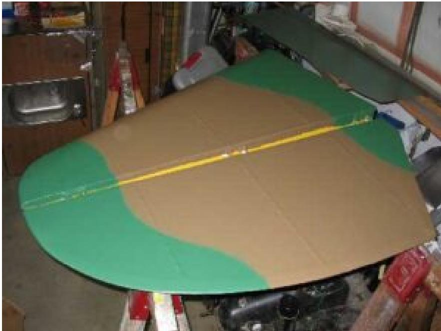
Au cours de mes vacances d'hiver j'ai été très occupé par Stringbag. Tout l'entoilage est en place, lardage et pose des bandes de renfort réalisés. Le fuselage a reçu l'apprêt, a été poncé et est prêt pour la peinture finale. Le moteur nu attend toujours l'installation du capot et des accessoires. Les poulies de freins sont installées et leur fonctionnement testé mais les câbles ne sont pas installés encore.
