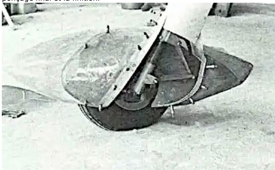
Ici, les carénages de roues avec leur nouveau carénage sont essayés pour vérifier leur ajustement avant d'entreprendre le nettoyage final.
