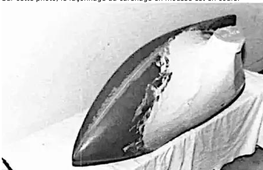
Le façonnage de la mousse est terminé et une couche d'enduit de rebouchage est appliquée comme protection contre les résines polyester.
