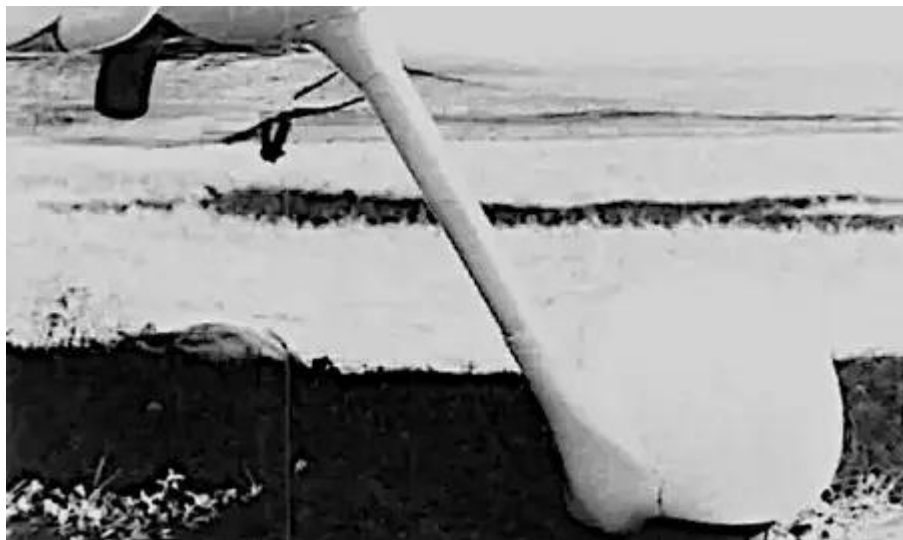
Une autre façon de personnaliser vos carénages de roues pour améliorer l'apparence et réduire la traînée.
