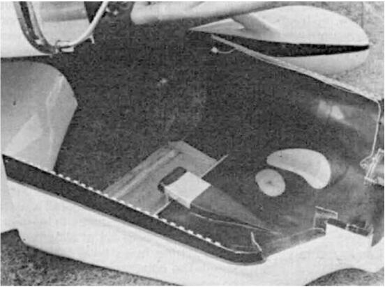
Voici l'intérieur d'un capot très bien conçu. Les deux sections de charnière piano, avec leurs axes amovibles, constituent une installation vraiment réussie. Remarquez également l'installation du phare d'atterrissage et sa fiche de déconnexion rapide.
