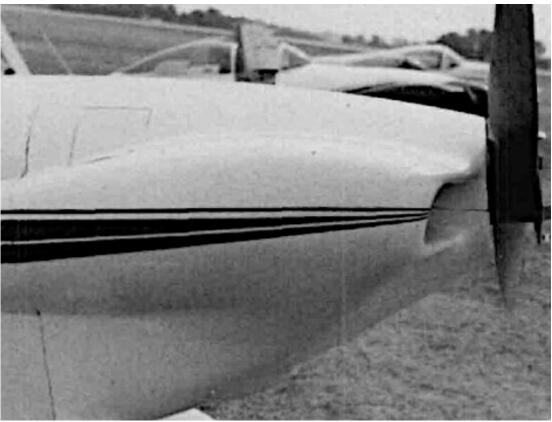
Dans la zone à courbure complexe où se trouve cette trappe de vérification de niveau d'huile, il est plus simple d'utiliser la partie découpée du capot comme trappe plutôt que d'en fabriquer une en métal.
