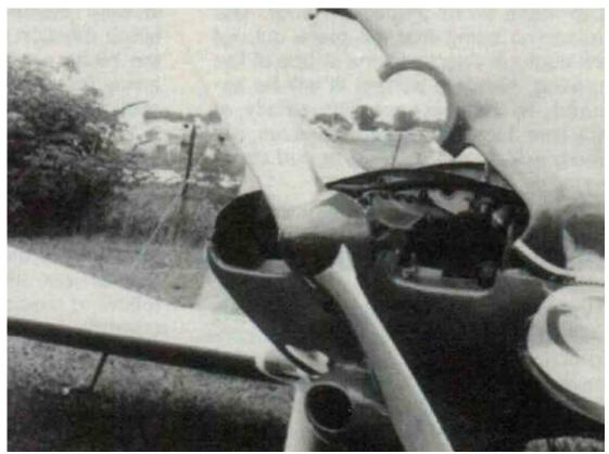
Voici une disposition intéressante. Il suffit de retirer un seul axe de charnière pour ouvrir le capot, ou les deux pour le déposer complètement. Aucune trappe d'inspection d'huile n'est nécessaire ici.
