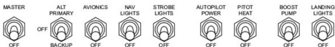
FIGURE 11 : interrupteurs incluant le pilote-auto et le réchauffage Pitot
