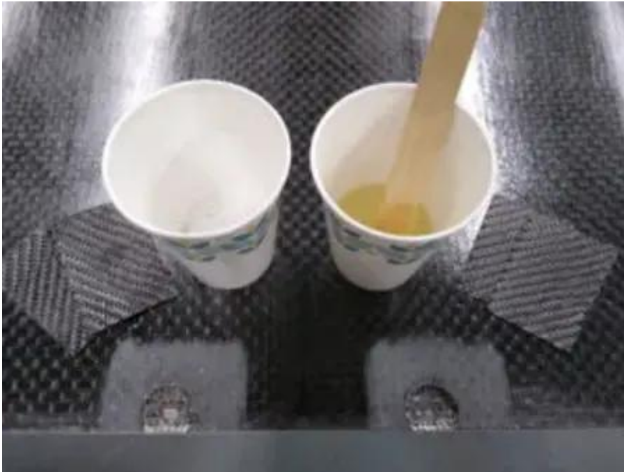
Photo 4 : Poncez légèrement autour de chaque point dur, préparez les pièces de réparation de la face tissu et mélangez l'époxy.
